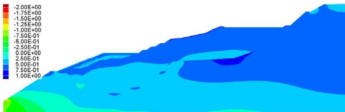
Gráfico 2.11.2.2-20 Modelo de Carga Estática FLAC, Estrés Vertical Total (Pa) del DR La Quinua
