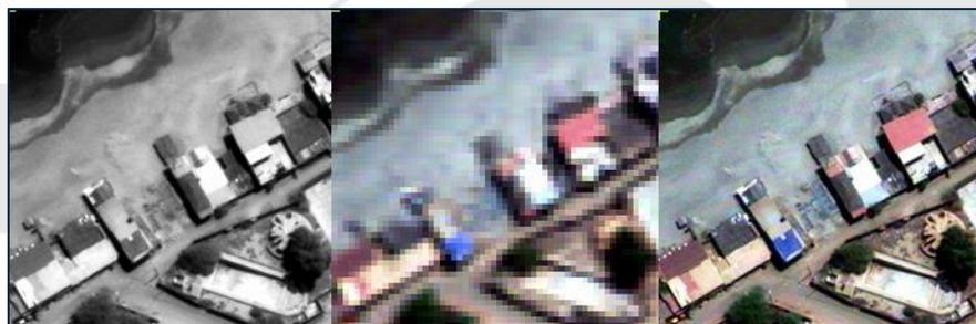
Figura 5. Se muestra la imagen pancromática, multiespectral y el pansharp.
