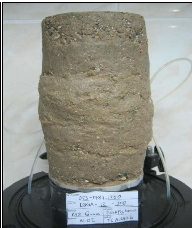
ESPECIMEN 2 Esfuerzo Efectivo Inicial 204 kPa
