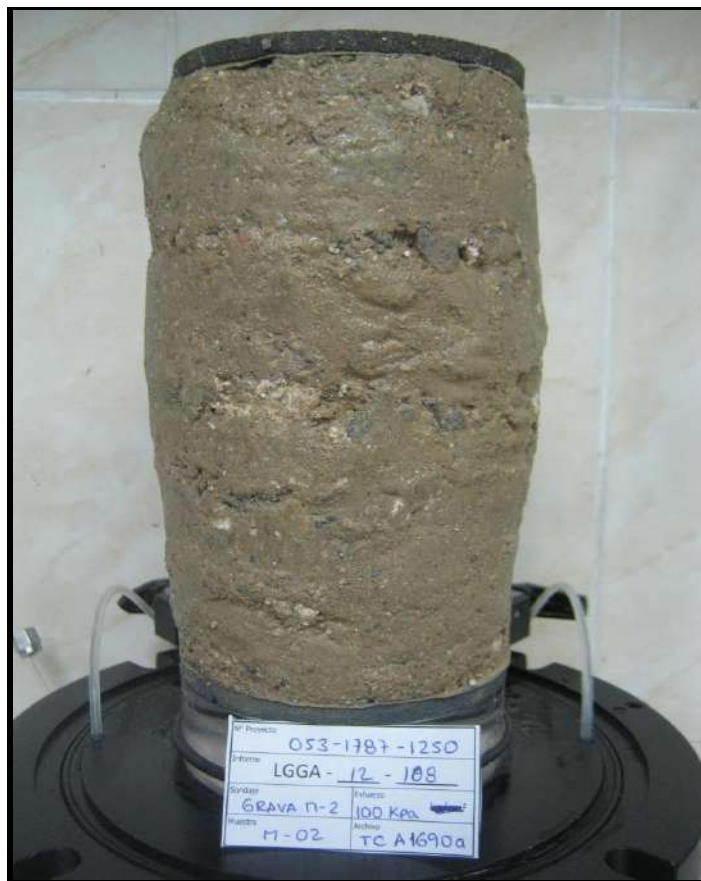
ESPECIMEN 1 Esfuerzo Efectivo Inicial 97 kPa
