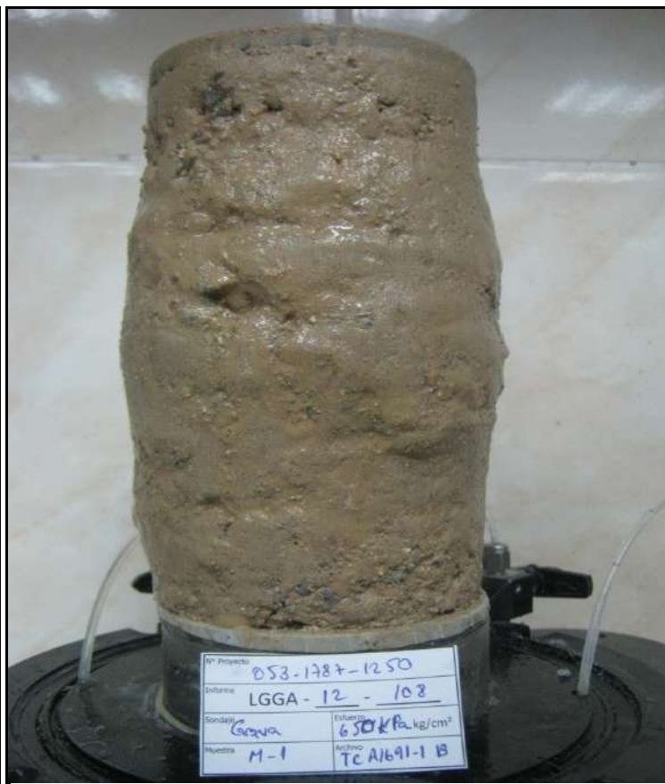
ESPECIMEN 2 Esfuerzo Efectivo Inicial 647 kPa
