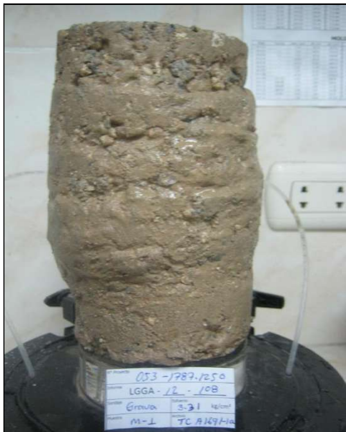
ESPECIMEN 1 Esfuerzo Efectivo Inicial 322 kPa
