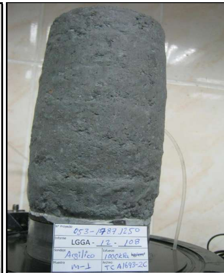
ESPECIMEN 3 Esfuerzo Efectivo Inicial 995 kPa
