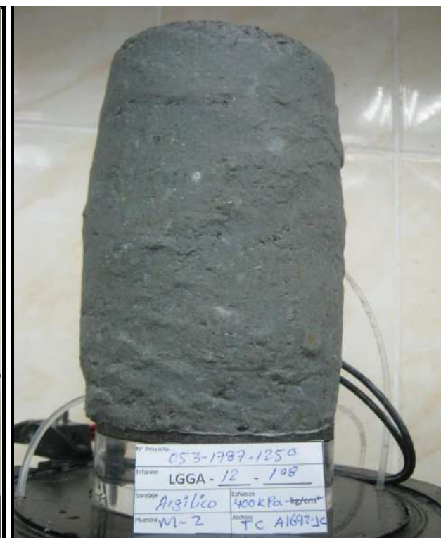
ESPECIMEN 3 Esfuerzo Efectivo Inicial 397 kPa
