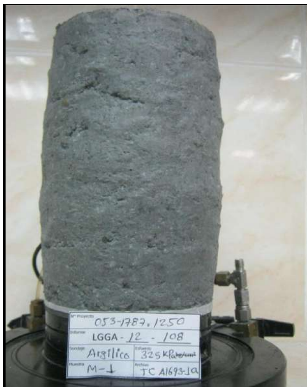
ESPECIMEN 1 Esfuerzo Efectivo Inicial 322 kPa
