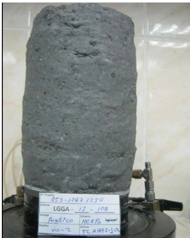
ESPECIMEN 1 Esfuerzo Efectivo Inicial 97 kPa
