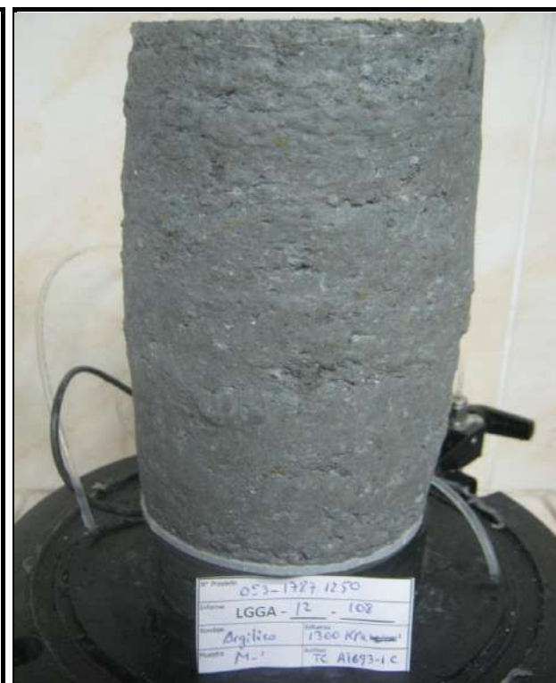
ESPECIMEN 3 Esfuerzo Efectivo Inicial 1306 kPa
