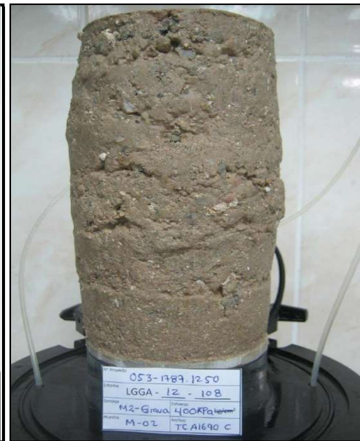
ESPECIMEN 3 Esfuerzo Efectivo Inicial 403 kPa
