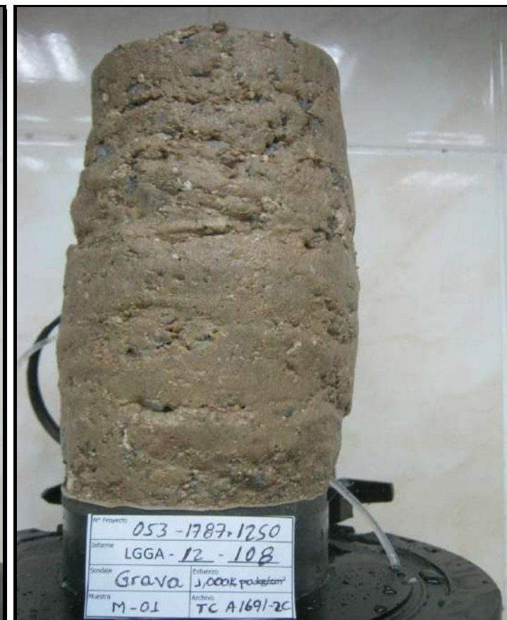
ESPECIMEN 3 Esfuerzo Efectivo Inicial 971 kPa
