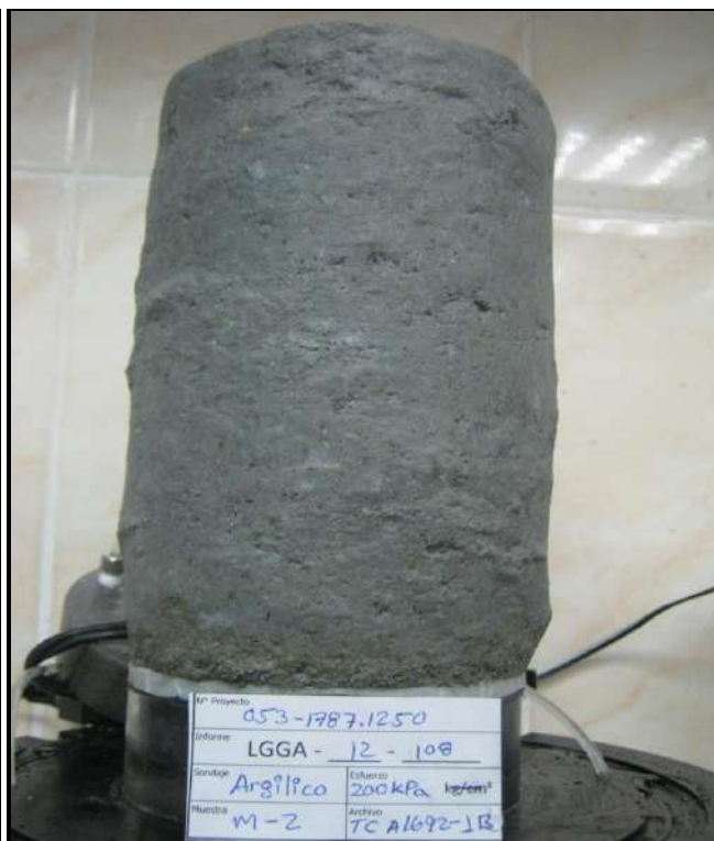
ESPECIMEN 2 Esfuerzo Efectivo Inicial 198 kPa
