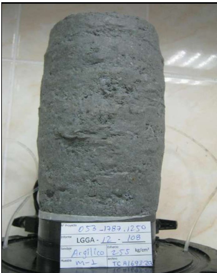
ESPECIMEN 1 Esfuerzo Efectivo Inicial 249 kPa
