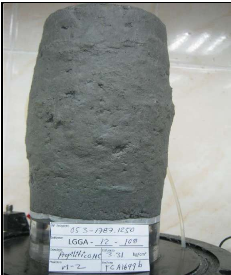
ESPECIMEN 2 Esfuerzo Efectivo Inicial 324 kPa
