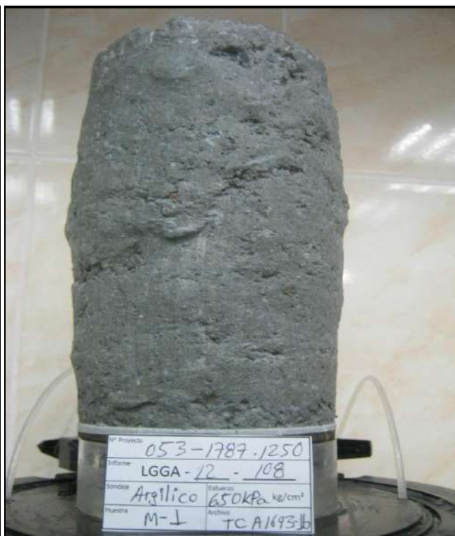
ESPECIMEN 2 Esfuerzo Efectivo Inicial 654 kPa
