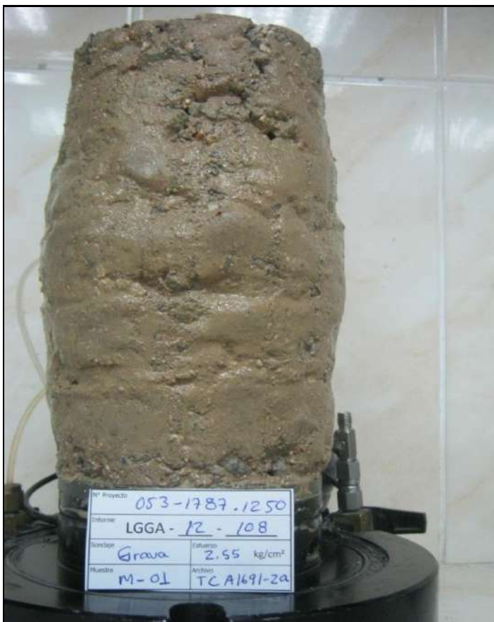
ESPECIMEN 1 Esfuerzo Efectivo Inicial 231 kPa
