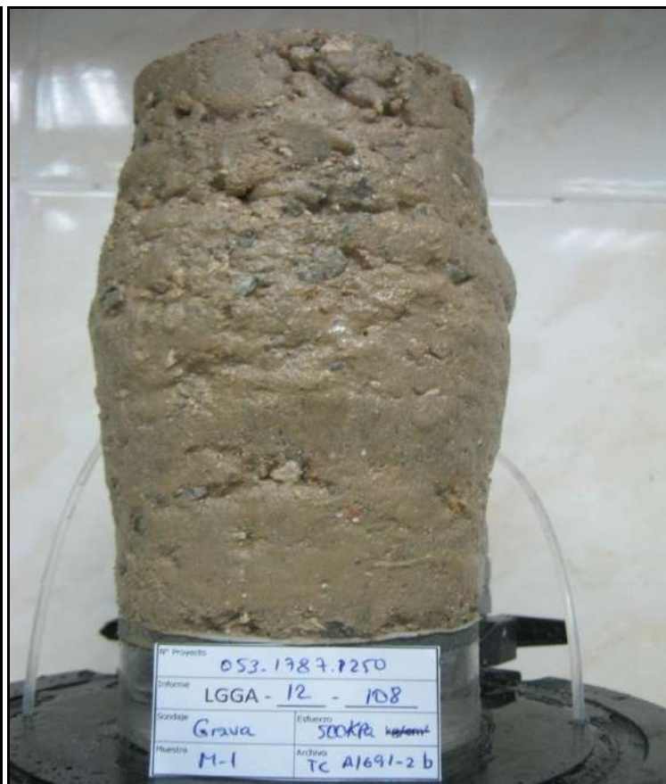
ESPECIMEN 2 Esfuerzo Efectivo Inicial 508 kPa
