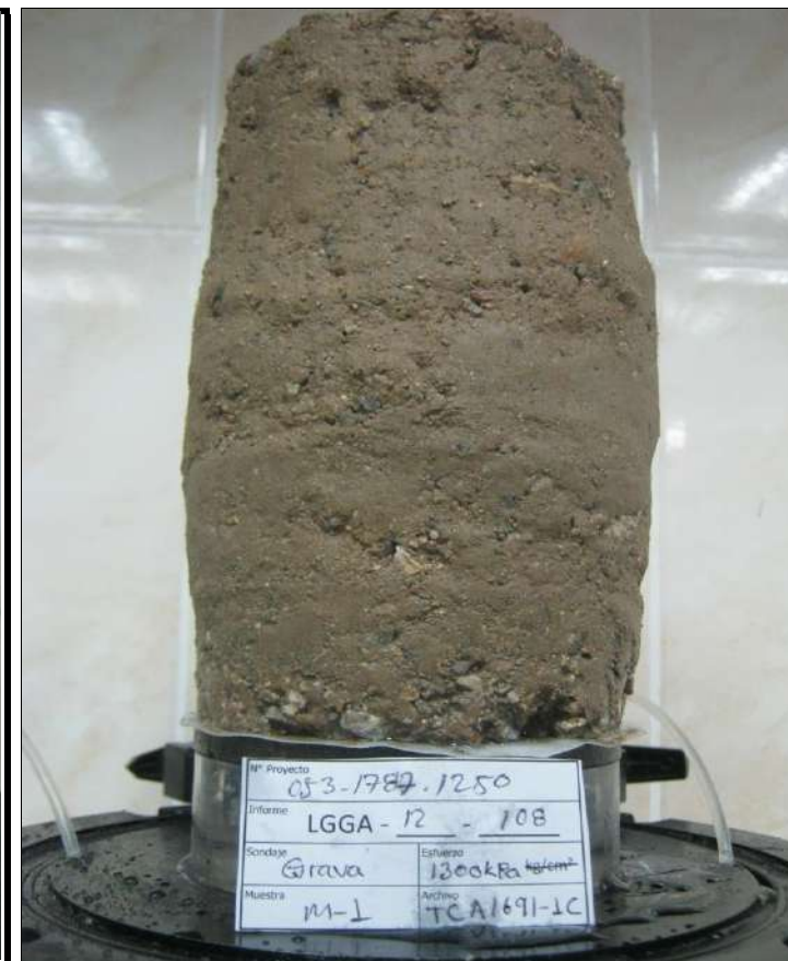
ESPECIMEN 3 Esfuerzo Efectivo Inicial 1299 kPa
