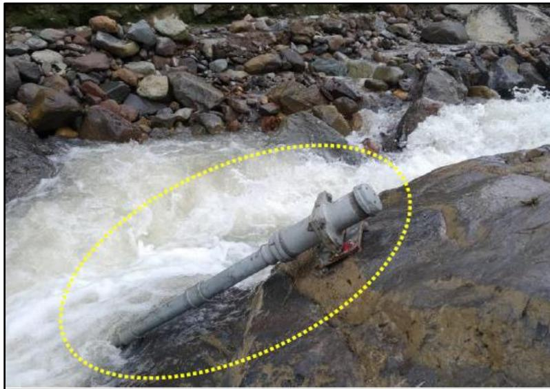
Fotografía 1.- Soporte metálico (transductor de presiones)
