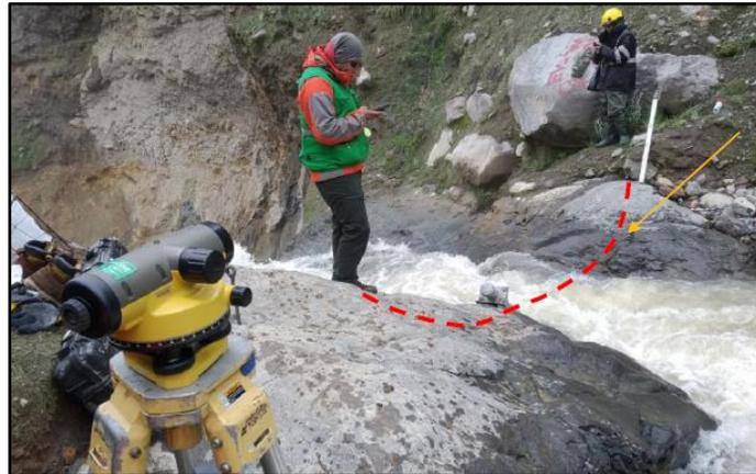
Fotografía 5.- Levantamiento sección hidráulica
