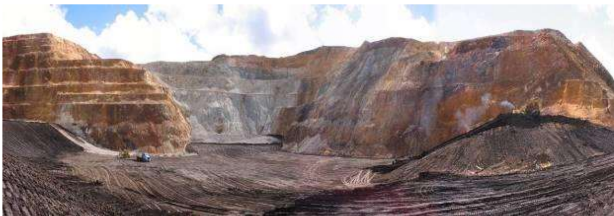
Foto 15 Aplicación de capa superficial orgánica del piso del tajo para revegetación
