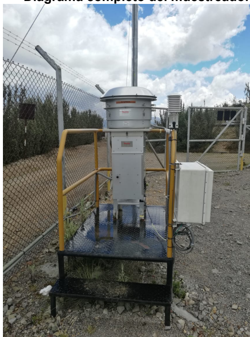
Diagrama completo del muestreador de Alto Volumen para PM10 o PM2.5
