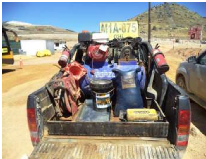
Figura N° 2 Sistema de contención (bandeja) en la tolva de camioneta para transporte de aceites y grasas. Los espacios vacíos sirven para colocar el Kit para derrames.
