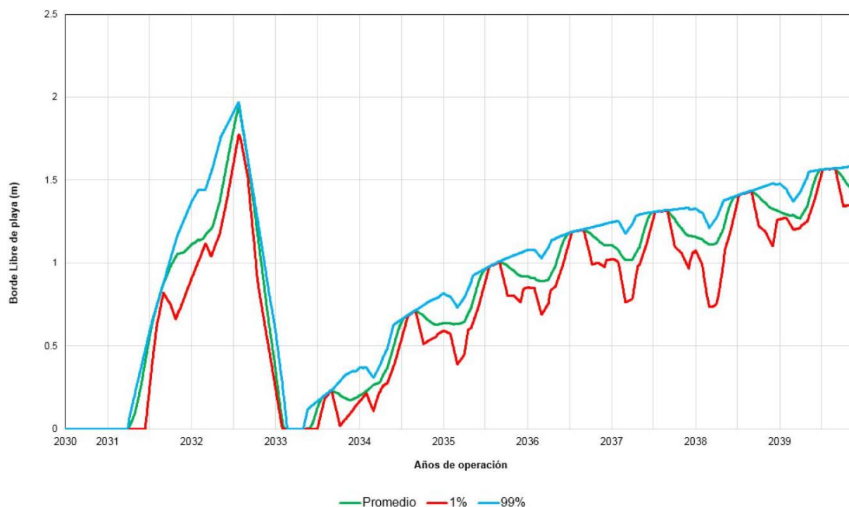
Gráfico 2.12.2.10-23 Borde libre de la playa para el depósito de relaves Pampa Larga – PMF 72 horas
