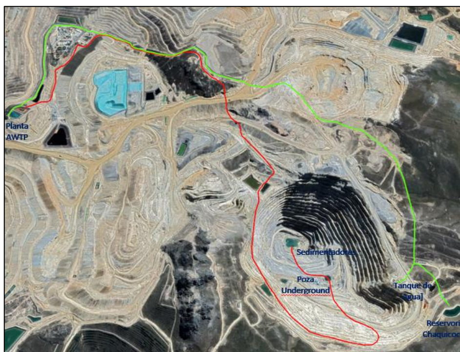
Esquema 2.11.2.2-2 Esquema del manejo de agua Tajo Chaquicocha a Planta AWTP
