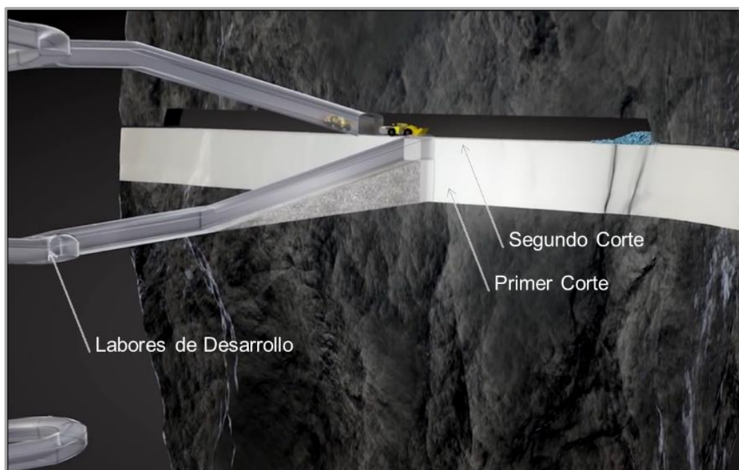
Esquema 2.12.2.2-4 Método de minado corte y relleno con sus variantes ascendente y descendente
