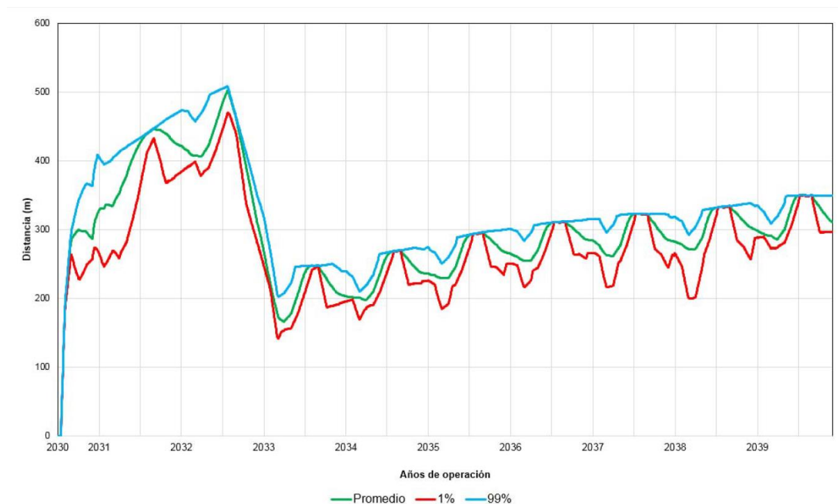
Gráfico 2.12.2.10-19 Distancia de la poza a la cara aguas arriba de la presa del depósito de relaves Pampa Larga
