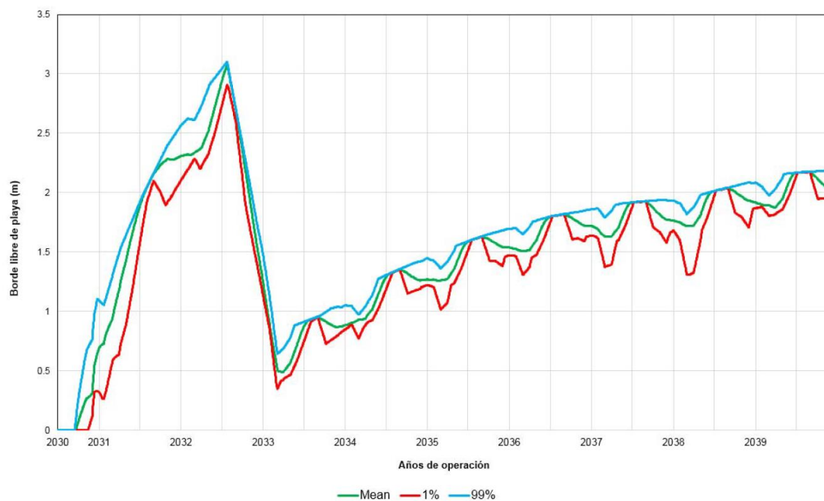
Gráfico 2.12.2.10-22 Borde libre de la playa para el depósito de relaves Pampa Larga – PMF 28 horas
