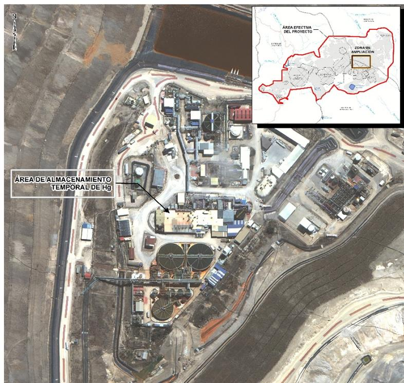
Este espacio cuenta con una losa de concreto que deriva hacia un sumidero en donde se colectaría cualquier flujo proveniente de la losa por procesos de limpieza principalmente, los cuales son bombeados desde dicho sumidero al proceso para su tratamiento. Cualquier presencia de mercurio obtenido de actividades de mantenimiento de la ex refinería es colectada por el personal de Procesos (con Equipos de Protección Personal adecuados a esta actividad), para luego proceder con el envasado respectivo.
