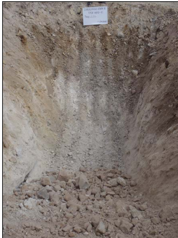
Fotografía 48: Calicata CCKPTP12-48, 2.20 m
