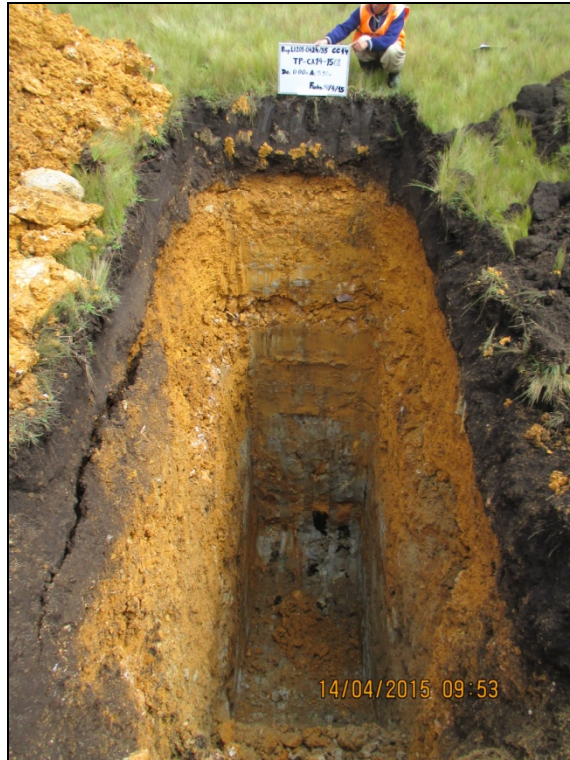
Fotografía 1: Calicata TP-CA14-1501, Profundidad 5.50 m.
