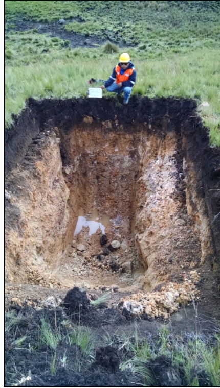
Fotografía 21: Calicata TP-CS2-1519, Profundidad 3.10 m.
