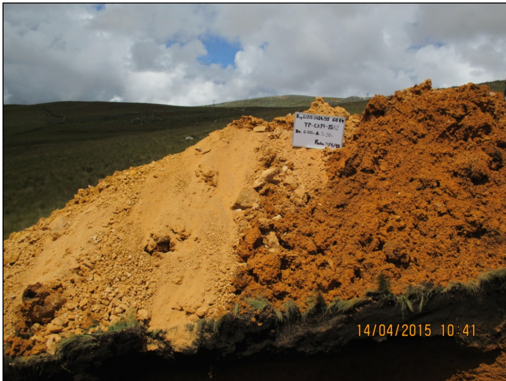
Fotografía 4: Material excavado de la calicata TP-CA14-1502.
