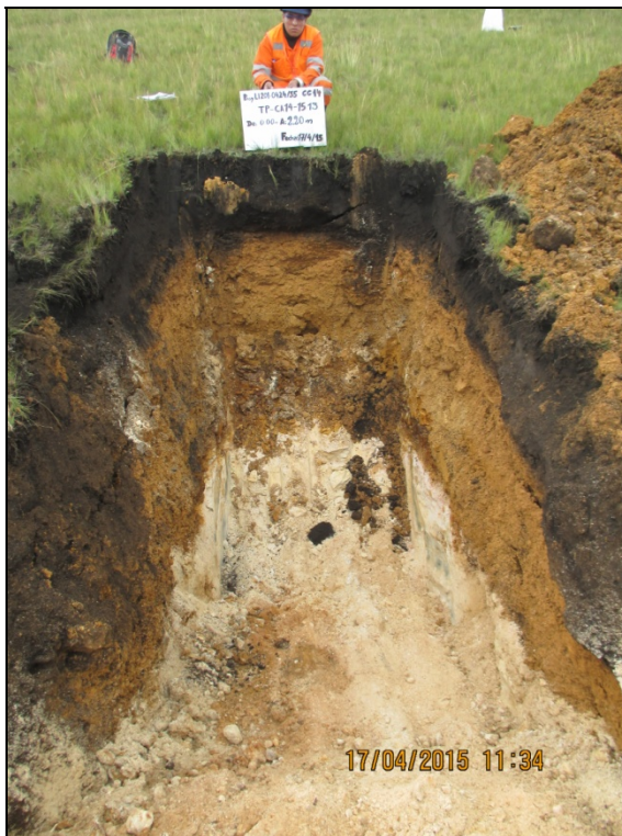
Fotografía 7: Calicata TP-CA14-1513, Profundidad 2.20 m.
