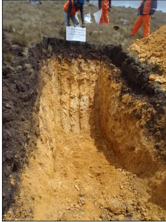
Fotografía 1: Calicata TP-CS2a-1529, Profundidad 5.20 m.
