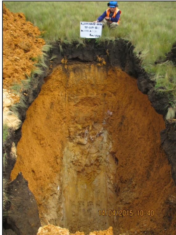
Fotografía 3: Calicata TP-CA14-1502, Profundidad 5.30 m.
