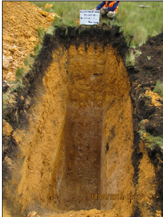
Fotografía 7: Calicata TP-CA14-1504, Profundidad 5.40 m.
