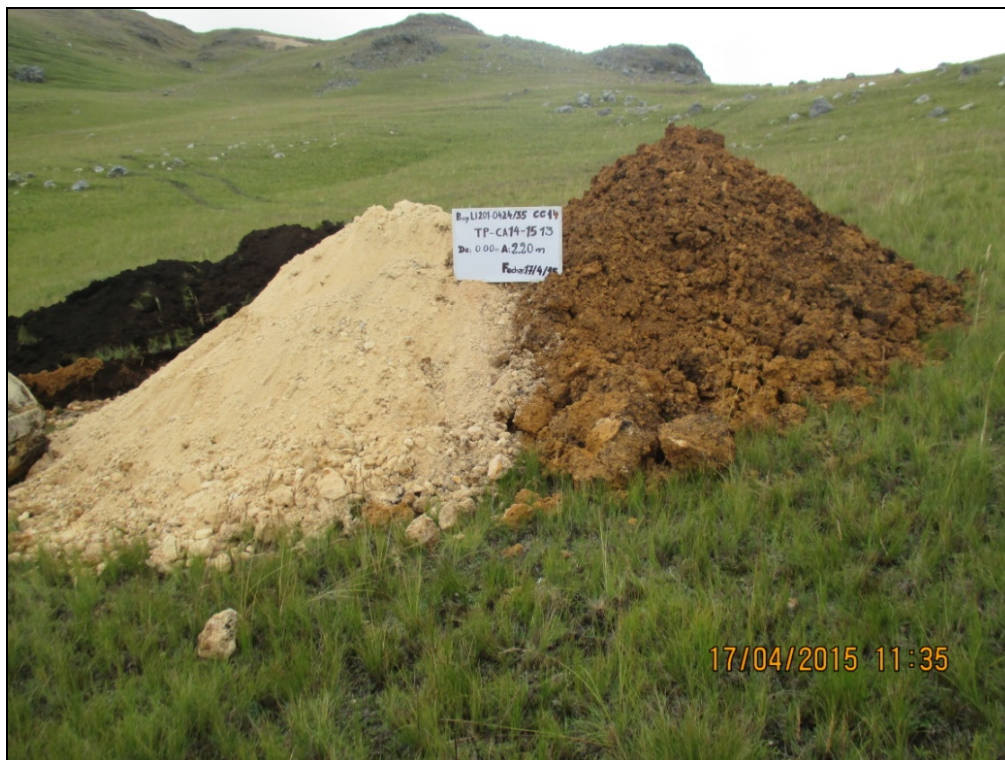
Fotografía 8: Material excavado de la calicata TP-CA14-1513.
