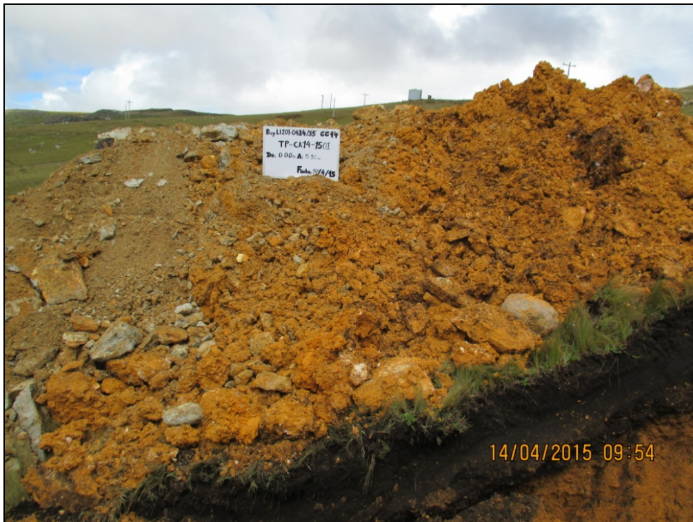
Fotografía 2: Material excavado de la calicata TP-CA14-1501.
