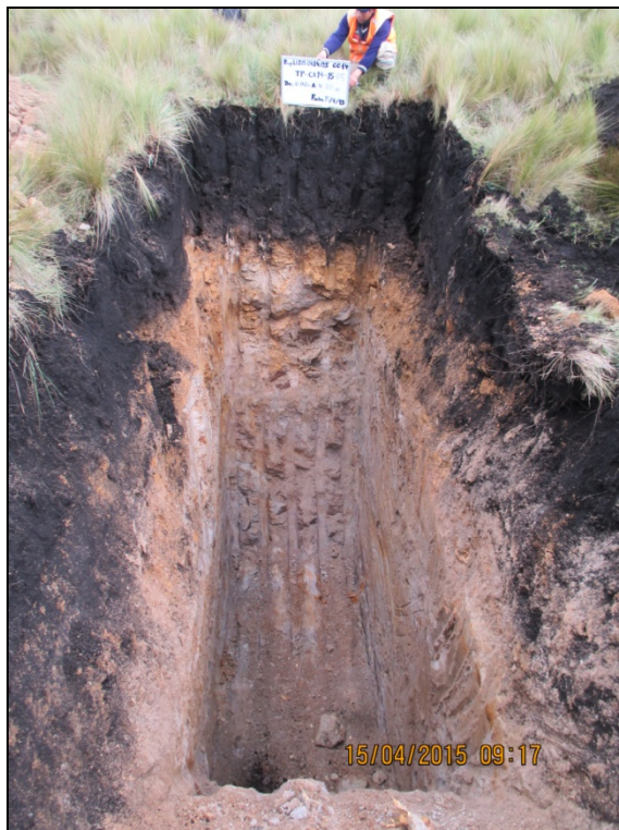
Fotografía 9: Calicata TP-CA14-1505, Profundidad 4.30 m.
