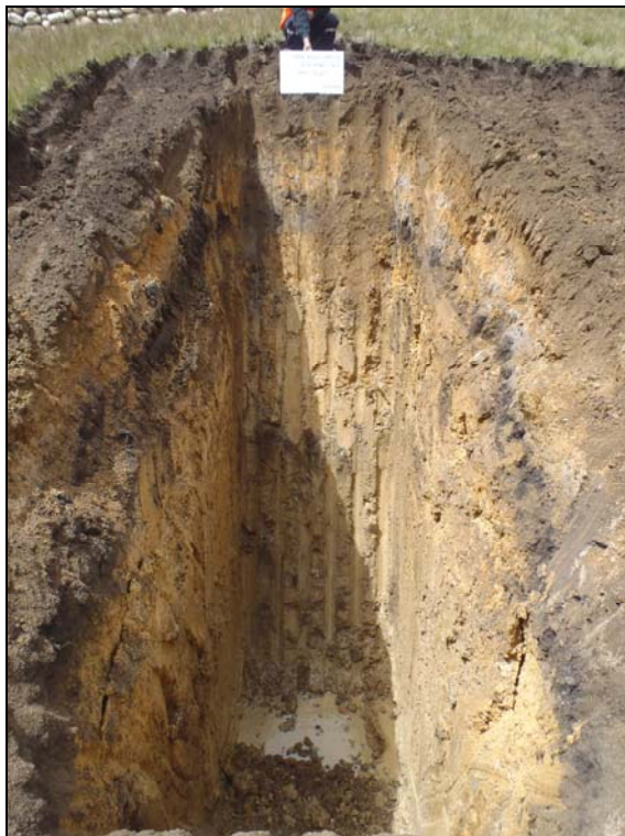
Fotografía 39: Calicata CCKPTP12-39, 4.60 m
