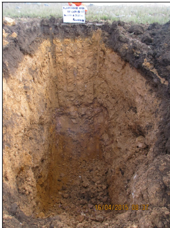
Fotografía 1: Calicata TP-CA14-1508, Profundidad 3.80 m.
