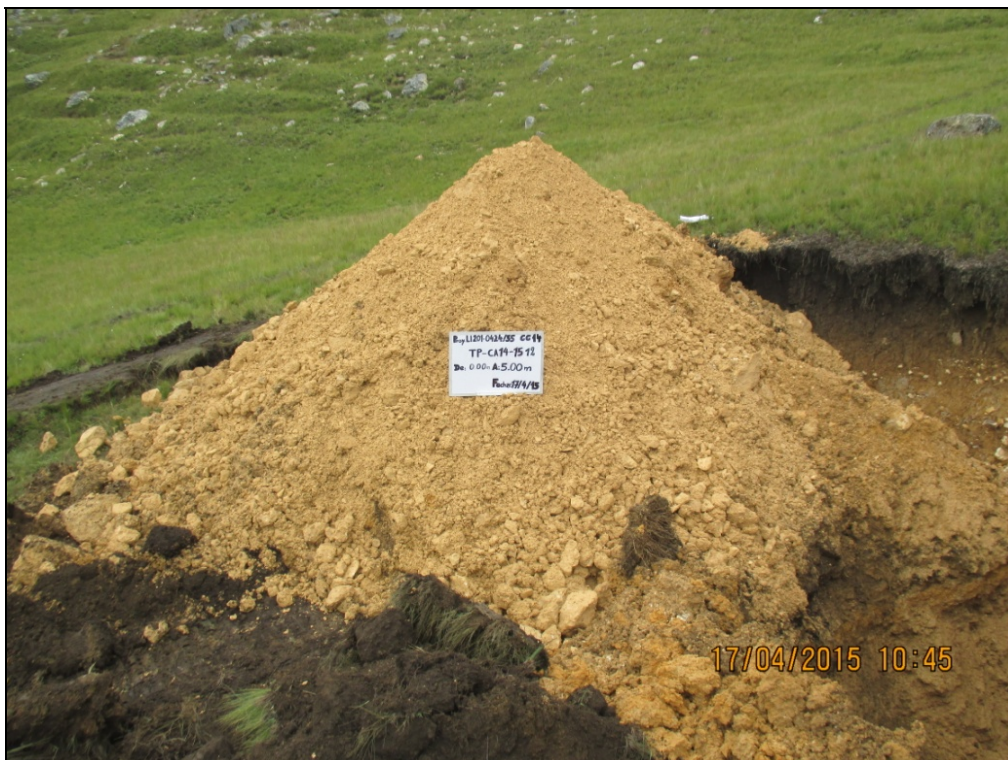
Fotografía 6: Material excavado de la calicata TP-CA14-1512.
