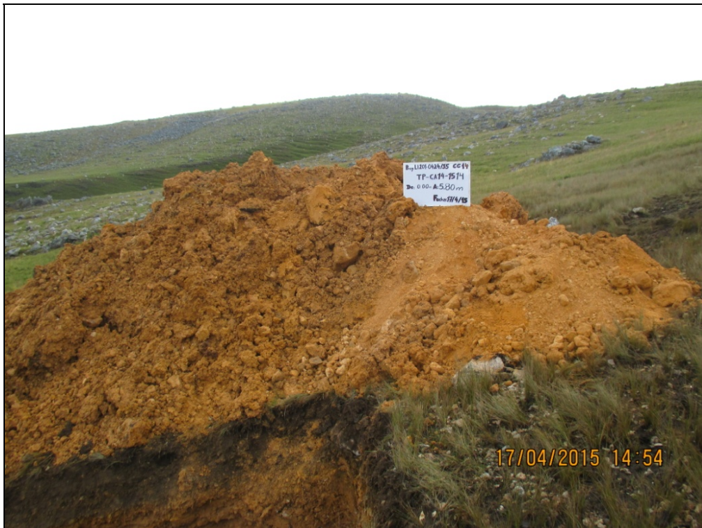
Fotografía 10: Material excavado de la calicata TP-CA14-1514.
