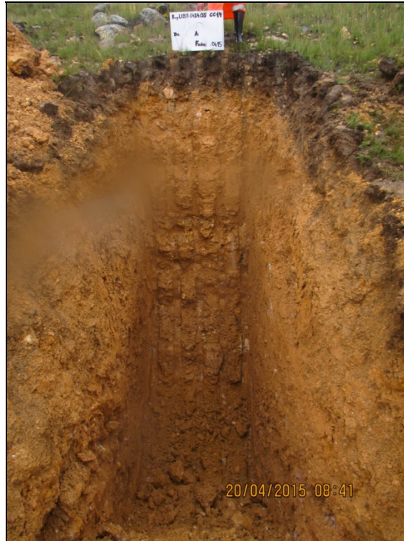
Fotografía 13: Calicata TP-CA14-1516, Profundidad 4.40 m.
