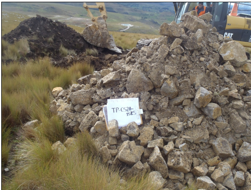
Fotografía 30: Material excavado de la calicata TP-CS2a-1525.
