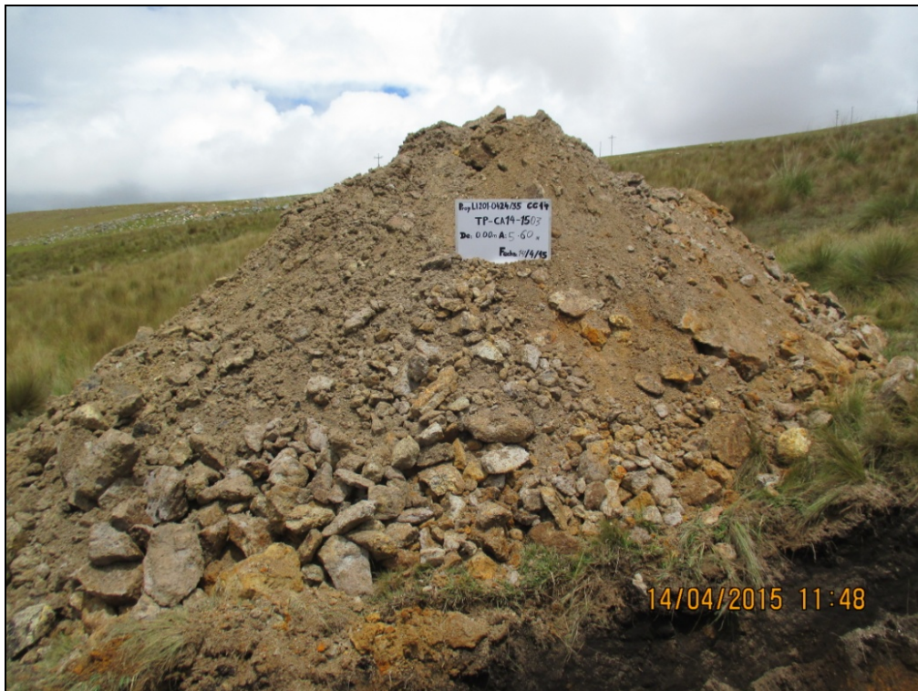
Fotografía 6: Material excavado de la calicata TP-CA14-1503.
