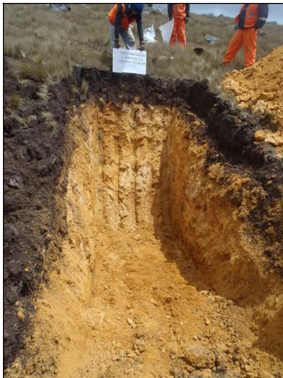
Fotografía 27: Calicata TP-CS2a-1529, Profundidad 5.20 m.
