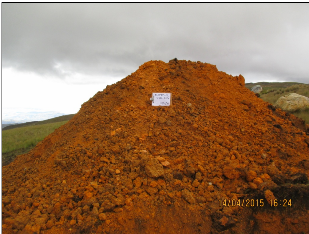
Fotografía 18: Material excavado de la calicata CAKPTP15-12.
