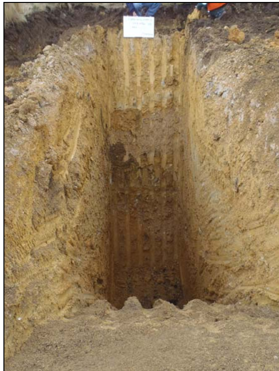
Fotografía 28: Calicata CCKPTP12-28, 4.80 m
