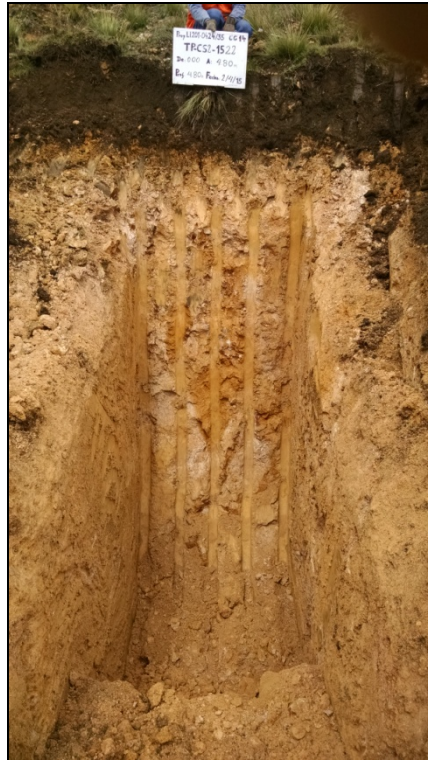
Fotografía 25: Calicata TP-CS2-1522, Profundidad 4.80 m.
