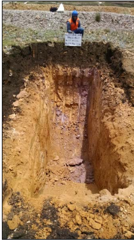
Fotografía 1: Calicata TP-CS1-1523, Profundidad 3.40 m.
