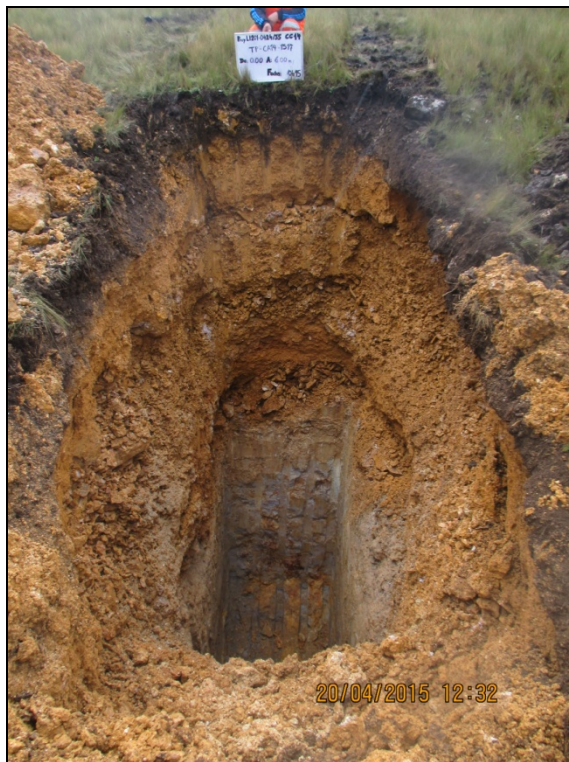
Fotografía 15: Calicata TP-CA14-1517, Profundidad 6.00 m.
