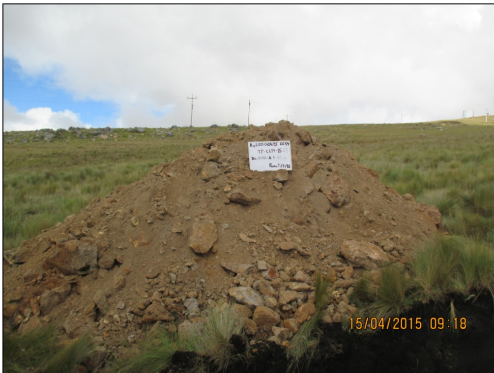
Fotografía 10: Material excavado de la calicata TP-CA14-1505.
