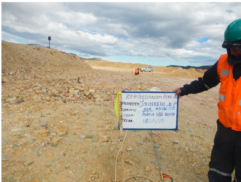
Fotografía 15: Vista panorámica de la zona de trabajo donde se realizó el ensayo sísmico MAM-08. Se observa el tendido del cable de refracción sísmica, una soga con medidas de ensayos y los geófonos. Asimismo, se aprecia una estaca con una cinta amarilla la cual indica el punto el cual ha sido replanteado.
