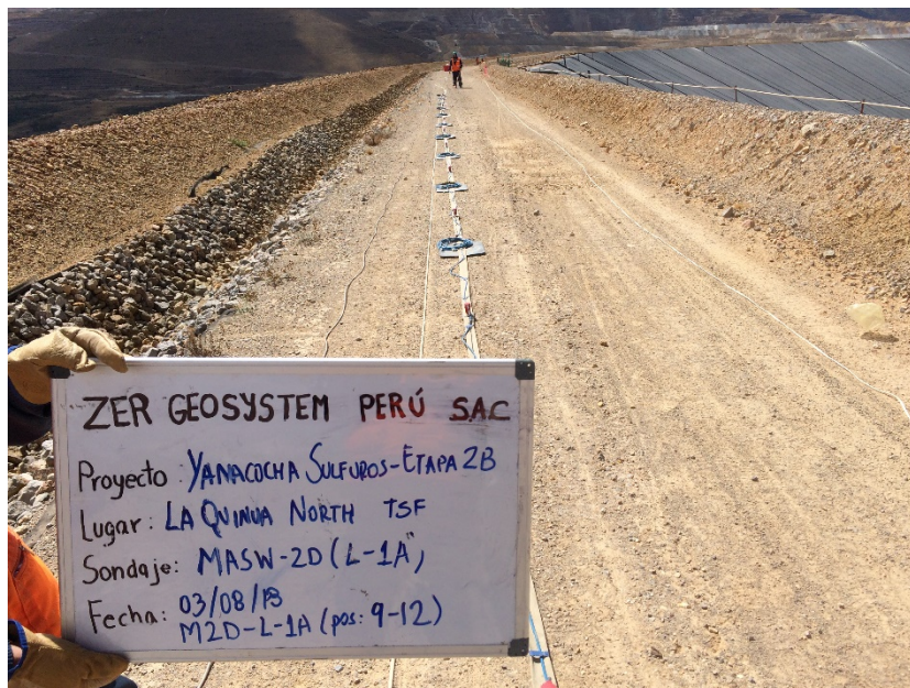
Fotografía 03: Vista panorámica de la zona de trabajo donde se realizó el ensayo sísmico MASW-2D. Se aprecia una faja unida al cable de refracción sísmica y los geófonos. En la fotografía se muestra las posiciones del 09 - 12 del presente ensayo.
