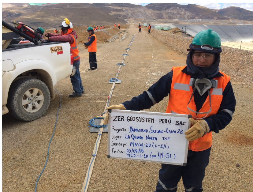
Fotografía 13: Vista panorámica de la zona de trabajo donde se realizó el ensayo sísmico MASW-2D. Se aprecia una faja unida al cable de refracción sísmica y los geófonos. En la fotografía se muestra las posiciones del 49 - 51 del presente ensayo.
