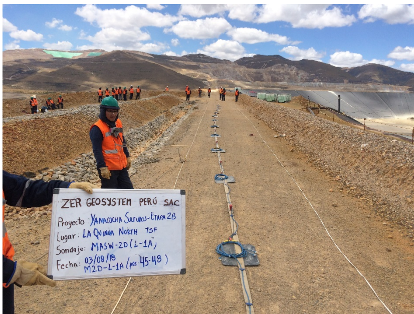
Fotografía 12: Vista panorámica de la zona de trabajo donde se realizó el ensayo sísmico MASW-2D. Se aprecia una faja unida al cable de refracción sísmica y los geófonos. En la fotografía se muestra las posiciones del 45 - 48 del presente ensayo.
