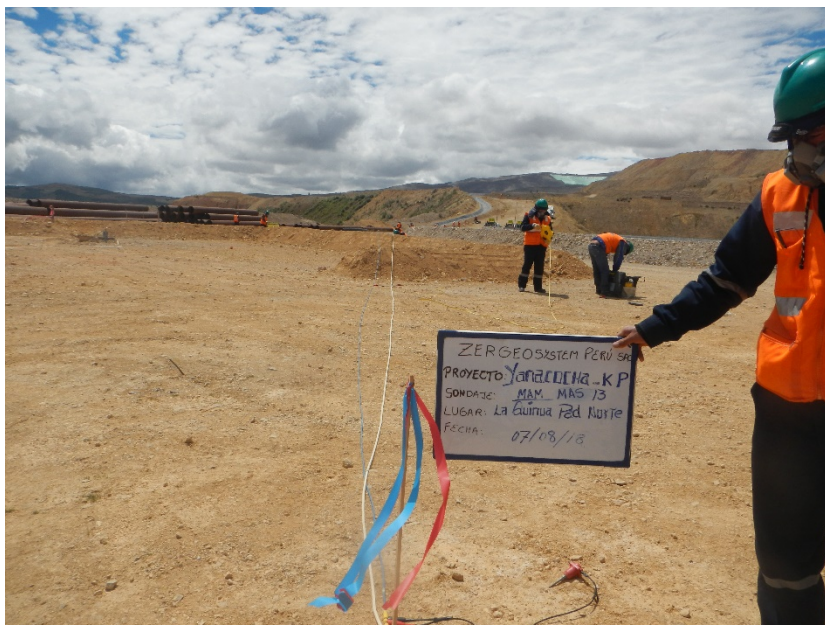
Fotografía 25: Vista panorámica de la zona de trabajo donde se realizó el ensayo sísmico MAM-13. Se observa el tendido del cable de refracción sísmica, una soga con medidas de ensayos y los geófonos. Asimismo, se aprecia una estaca con una cinta azul con rosa la cual indica el punto el cual ha sido replanteado.
