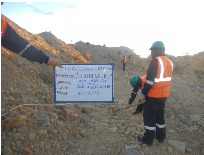
Fotografía 14: Vista panorámica de la zona de trabajo donde se realizó el ensayo sísmico MASW-07. Se observa el tendido del cable trigger, geófonos y el accionar de la comba propia del ensayo.
