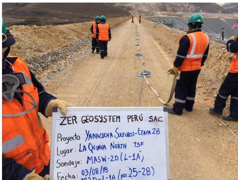
Fotografía 07: Vista panorámica de la zona de trabajo donde se realizó el ensayo sísmico MASW-2D. Se aprecia una faja unida al cable de refracción sísmica y los geófonos. En la fotografía se muestra las posiciones del 25 - 28 del presente ensayo.
