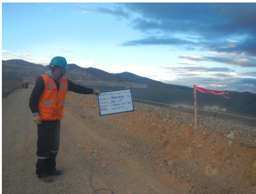
Fotografía 02: Vista panorámica de la zona de trabajo donde se realizó el ensayo sísmico MAM-02. Se observa el tendido del cable de refracción sísmica, una sogu con medidas de ensayos y los geófonos. Asimismo, se aprecia una estaca con una cinta rosa la cual indica el punto el cual no ha sido replanteado.
