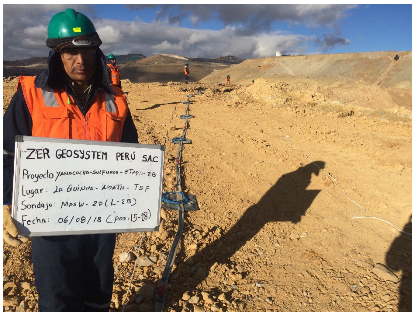
Fotografía 18: Vista panorámica de la zona de trabajo donde se realizó el ensayo sísmico MASW-2D. Se aprecia una faja unida al cable de refracción sísmica y los geófonos. En la fotografía se muestra las posiciones del 15 - 18 del presente ensayo.
