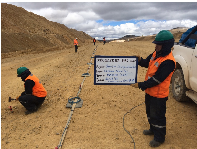
Fotografía 42: Vista panorámica de la zona de trabajo donde se realizó el ensayo sísmico MASW-2D. Se aprecia una faja unida al cable de refracción sísmica y los geófonos. En la fotografía se muestra las posiciones del 87 - 90 del presente ensayo.
