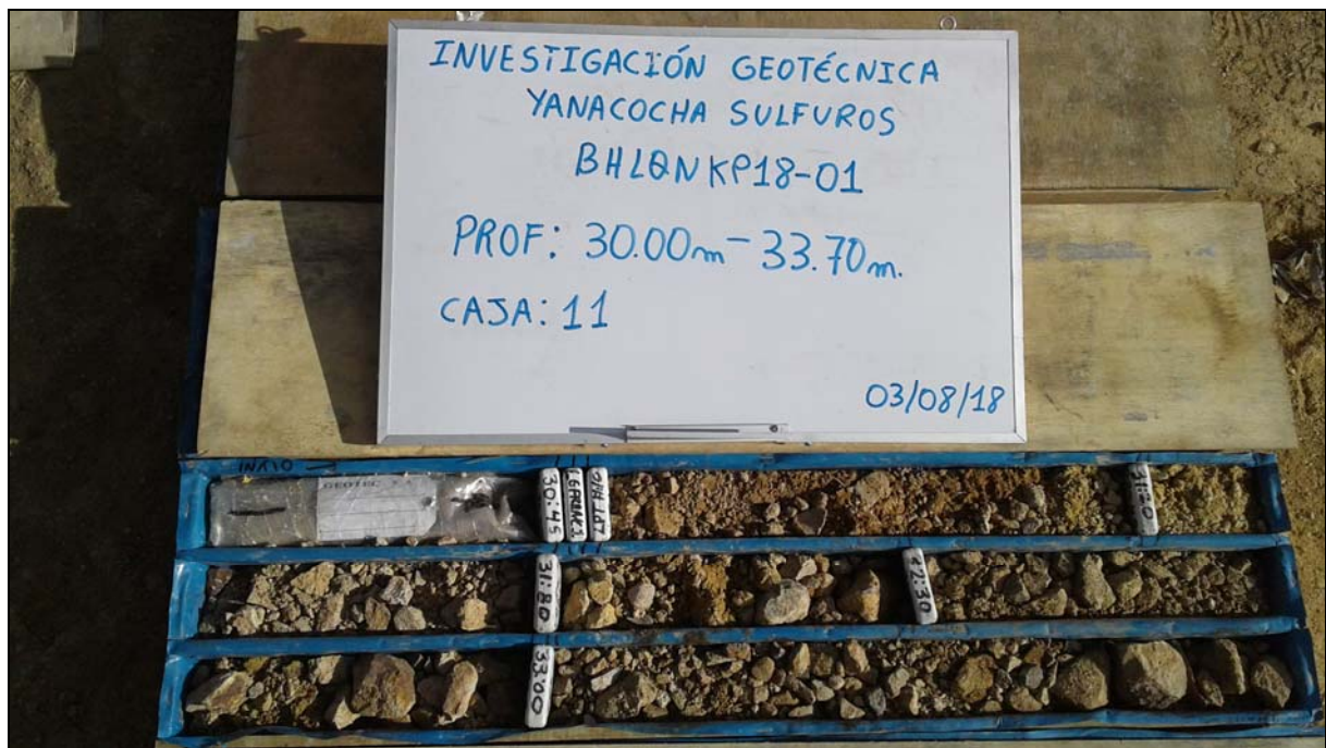
Fotografía 11: Perforación BHLQN KP18-01 De 30,00 m a 33,70 m.
