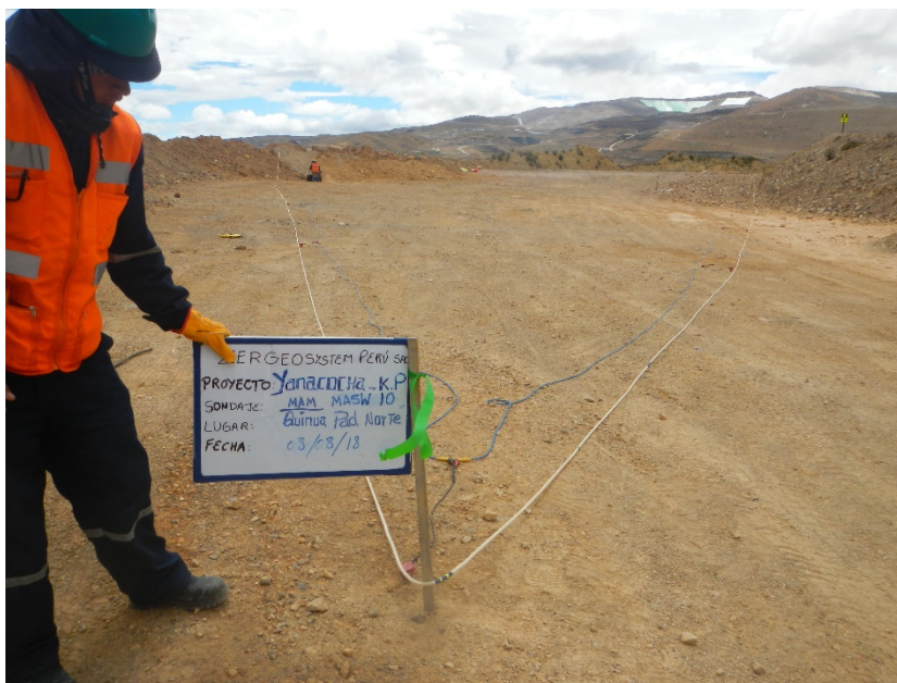
Fotografía 19: Vista panorámica de la zona de trabajo donde se realizó el ensayo sísmico MAM-10. Se observa el tendido del cable de refracción sísmica, una soga con medidas de ensayos y los geófonos. Asimismo, se aprecia una estaca con una cinta verde la cual indica el punto el cual ha sido replanteado.
