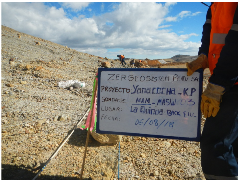
Fotografía 05: Vista panorámica de la zona de trabajo donde se realizó el ensayo sísmico MAM-03. Se observa el tendido del cable de refracción sísmica, una soga con medidas de ensayos y los geófonos. Asimismo, se aprecia una estaca con una cinta rosa y verde la cual indica el punto el cual no ha sido replanteado.
