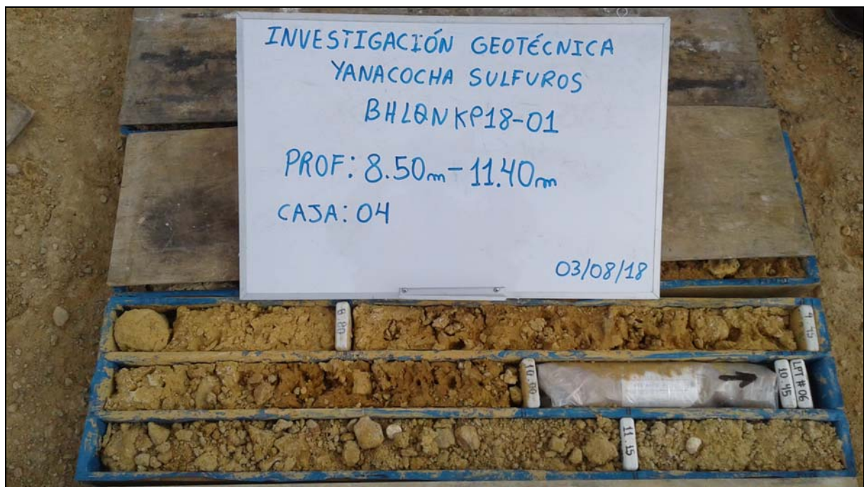
Fotografía 4: Perforación BHLQN KP18-01 De 8,50 m a 11,40 m.
