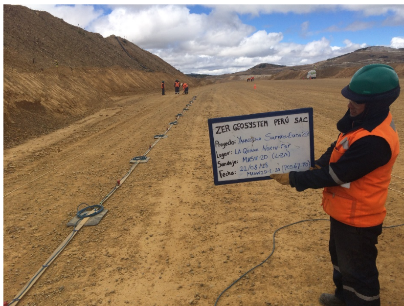
Fotografía 37: Vista panorámica de la zona de trabajo donde se realizó el ensayo sísmico MASW-2D. Se aprecia una faja unida al cable de refracción sísmica y los geófonos. En la fotografía se muestra las posiciones del 67 - 70 del presente ensayo.
