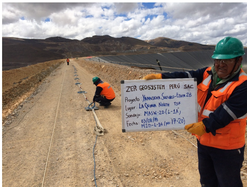
Fotografía 05: Vista panorámica de la zona de trabajo donde se realizó el ensayo sísmico MASW-2D. Se aprecia una faja unida al cable de refracción sísmica y los geófonos. En la fotografía se muestra las posiciones del 17 - 20 del presente ensayo.
