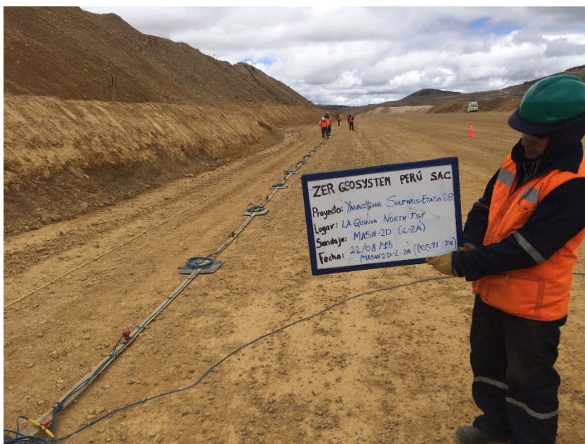
Fotografía 38: Vista panorámica de la zona de trabajo donde se realizó el ensayo sísmico MASW-2D. Se aprecia una faja unida al cable de refracción sísmica y los geófonos. En la fotografía se muestra las posiciones del 71 - 74 del presente ensayo.
