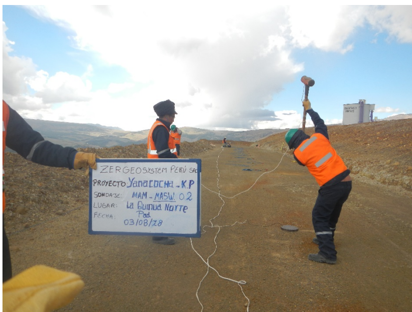
Fotografía 04: Vista panorámica de la zona de trabajo donde se realizó el ensayo sísmico MASW-02. Se observa el tendido del cable trigger, geófonos y el accionar de la comba propia del ensayo.
