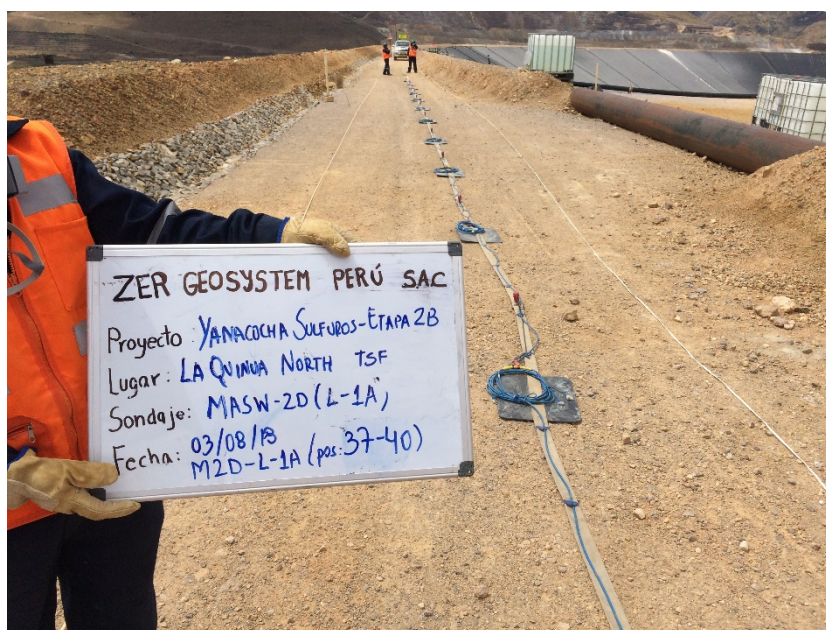
Fotografía 10: Vista panorámica de la zona de trabajo donde se realizó el ensayo sísmico MASW-2D. Se aprecia una faja unida al cable de refracción sísmica y los geófonos. En la fotografía se muestra las posiciones del 37 - 40 del presente ensayo.
