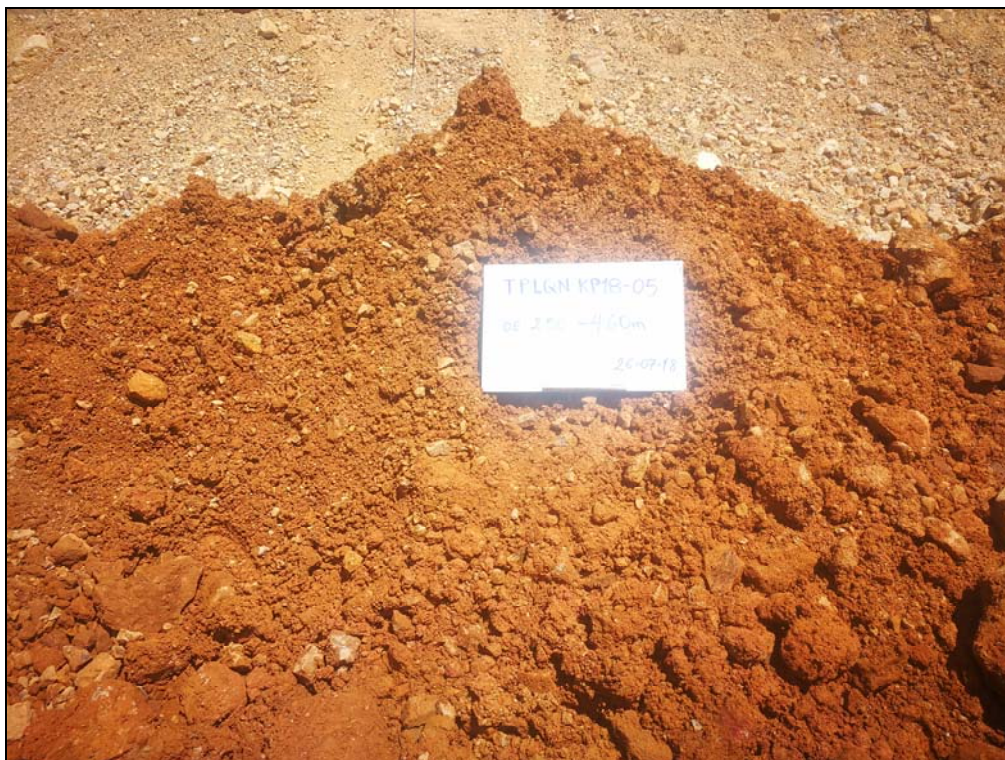
Fotografía 10: Material excavado de la calicata TPLQN KP18-05.
