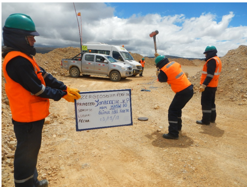
Fotografía 20: Vista panorámica de la zona de trabajo donde se realizó el ensayo sísmico MASW-10. Se observa el tendido del cable trigger, geófonos y la comba propia del ensayo.
