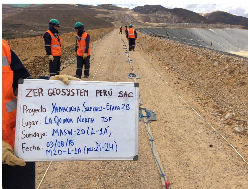
Fotografía 06: Vista panorámica de la zona de trabajo donde se realizó el ensayo sísmico MASW-2D. Se aprecia una faja unida al cable de refracción sísmica y los geófonos. En la fotografía se muestra las posiciones del 21 - 24 del presente ensayo.
