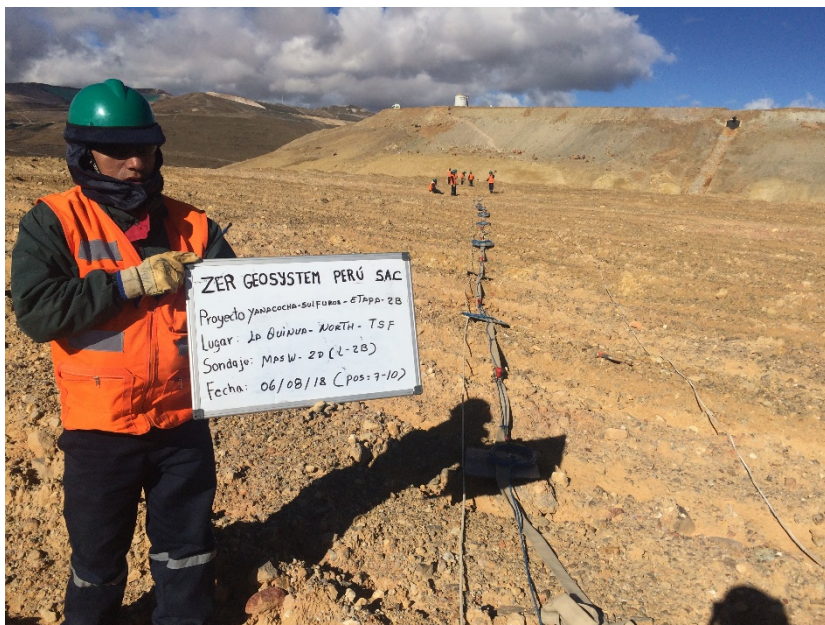
Fotografía 16: Vista panorámica de la zona de trabajo donde se realizó el ensayo sísmico MASW-2D. Se aprecia una faja unida al cable de refracción sísmica y los geófonos. En la fotografía se muestra las posiciones del 7 - 10 del presente ensayo.
