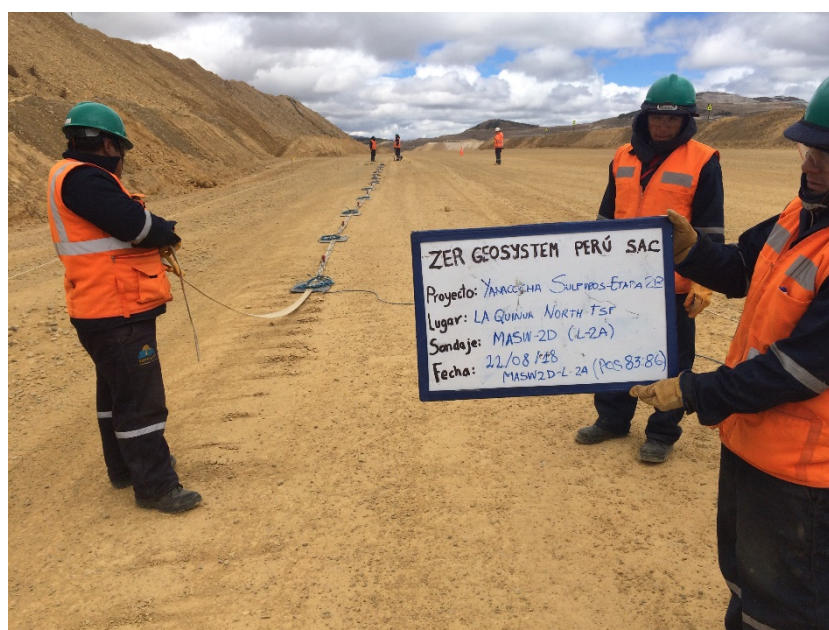
Fotografía 41: Vista panorámica de la zona de trabajo donde se realizó el ensayo sísmico MASW-2D. Se aprecia una faja unida al cable de refracción sísmica y los geófonos. En la fotografía se muestra las posiciones del 83 - 86 del presente ensayo.
