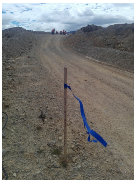
Fotografía 06: Vista panorámica de la zona de trabajo donde se realizó el ensayo sísmico TE-03. En la fotografía, se observa el punto (estaca) con una cinta azul donde se realizó el ensayo, lo que indica que hubo replanteo del punto.
