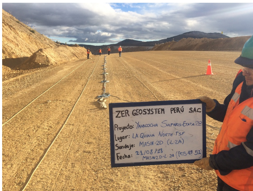
Fotografía 32: Vista panorámica de la zona de trabajo donde se realizó el ensayo sísmico MASW-2D. Se aprecia una faja unida al cable de refracción sísmica y los geófonos. En la fotografía se muestra las posiciones del 49 - 52 del presente ensayo.
