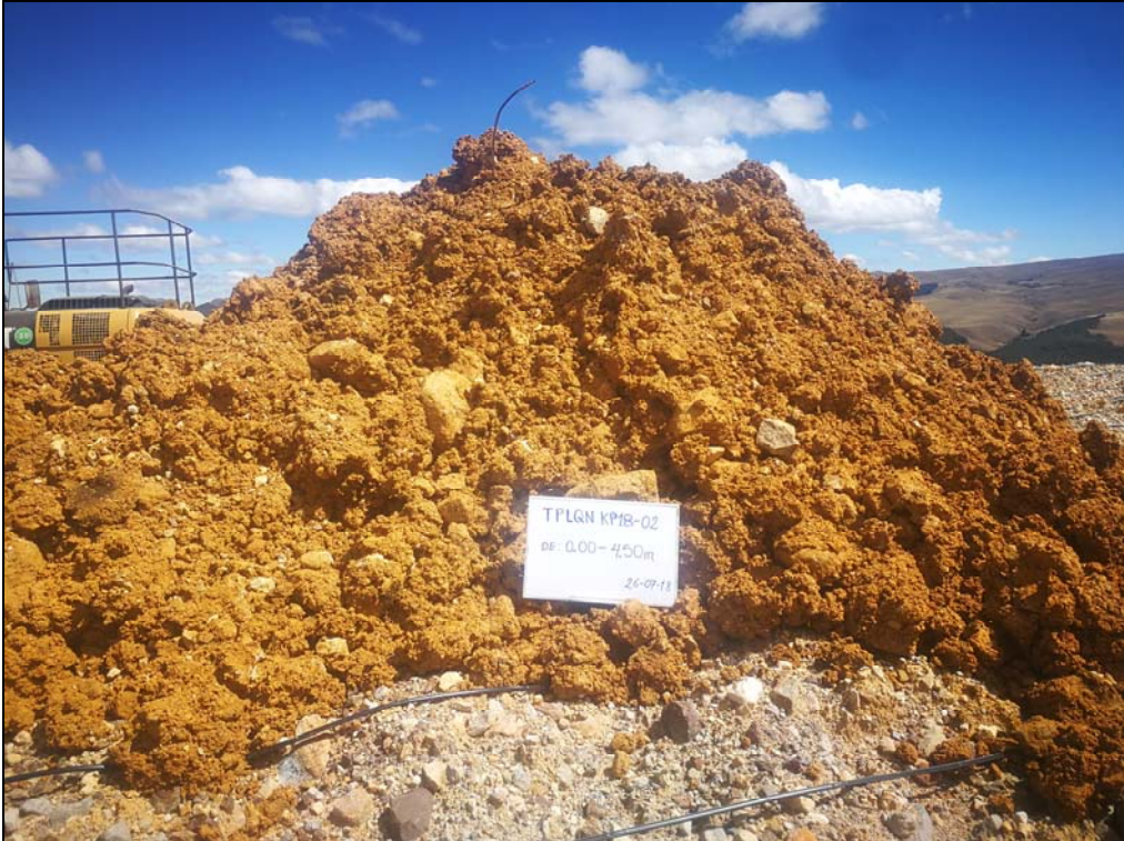
Fotografía 4: Material excavado de la calicata TPLQN KP18-02.
