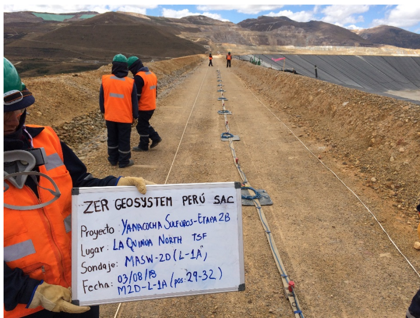
Fotografía 08: Vista panorámica de la zona de trabajo donde se realizó el ensayo sísmico MASW-2D. Se aprecia una faja unida al cable de refracción sísmica y los geófonos. En la fotografía se muestra las posiciones del 29 - 32 del presente ensayo.
