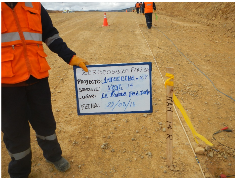
Fotografía 14: Vista panorámica de la zona de trabajo donde se realizó el ensayo sísmico MAM-14. Se observa el tendido del cable de refracción sísmica, una soga con medidas de ensayos y los geófonos. Asimismo, se aprecia una estaca con una cinta amarilla la cual indica el punto el cual ha sido replanteado.
