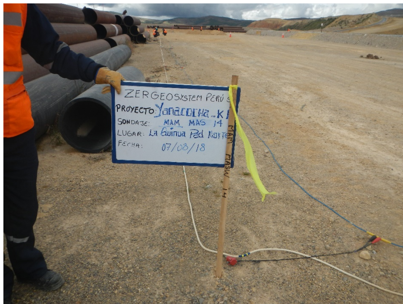
Fotografía 27: Vista panorámica de la zona de trabajo donde se realizó el ensayo sísmico MAM-14. Se observa el tendido del cable de refracción sísmica, una soga con medidas de ensayos y los geófonos. Asimismo, se aprecia una estaca con una cinta amarilla la cual indica el punto el cual ha sido replanteado.
