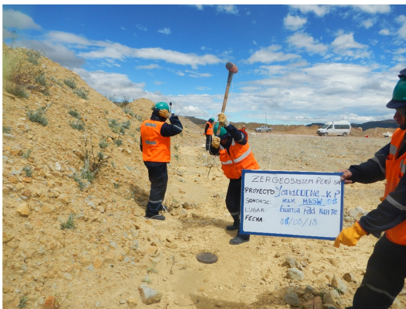
Fotografía 16: Vista panorámica de la zona de trabajo donde se realizó el ensayo sísmico MASW-08. Se observa el tendido del cable trigger, geófonos y el accionar de la comba propia del ensayo.
