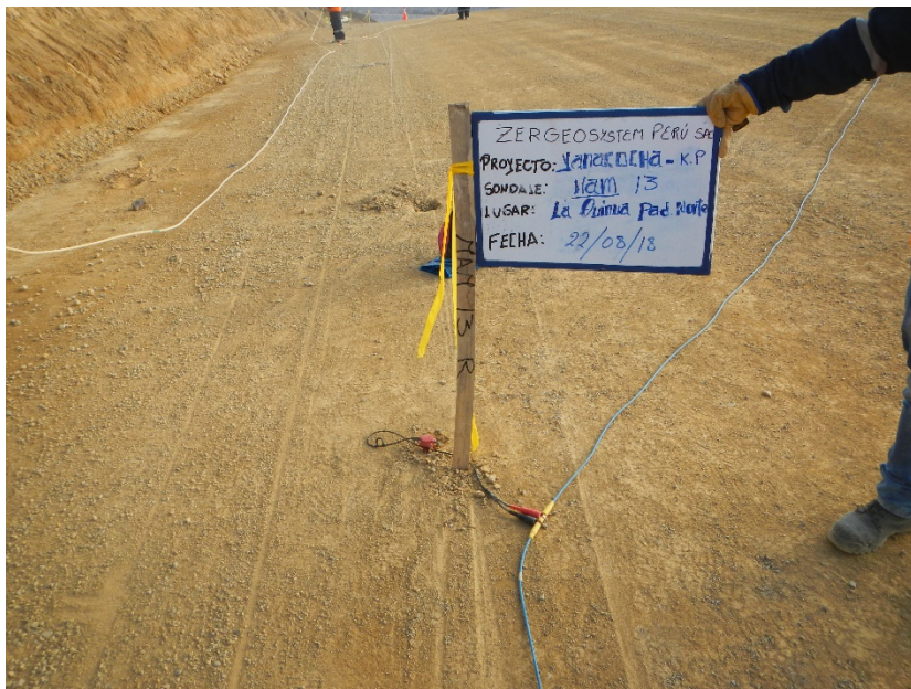
Fotografía 13: Vista panorámica de la zona de trabajo donde se realizó el ensayo sísmico MAM-13. Se observa el tendido del cable de refracción sísmica, una soga con medidas de ensayos y los geófonos. Asimismo, se aprecia una estaca con una cinta amarilla la cual indica el punto el cual ha sido replanteado.
