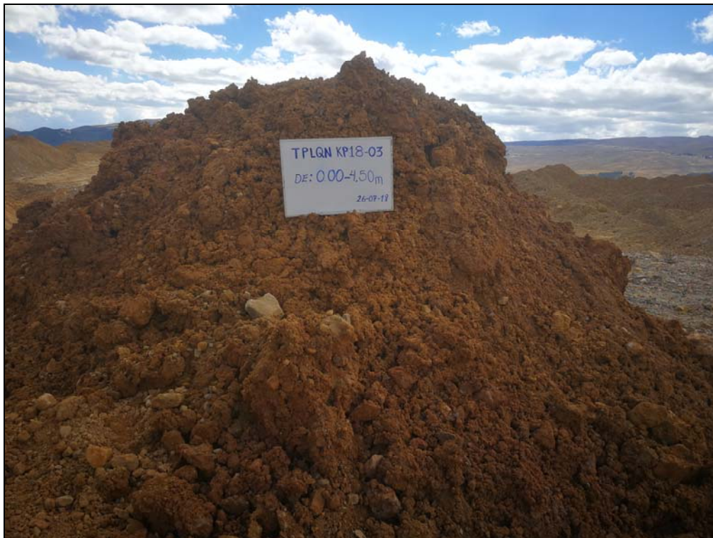
Fotografía 6: Material excavado de la calicata TPLQN KP18-03.
