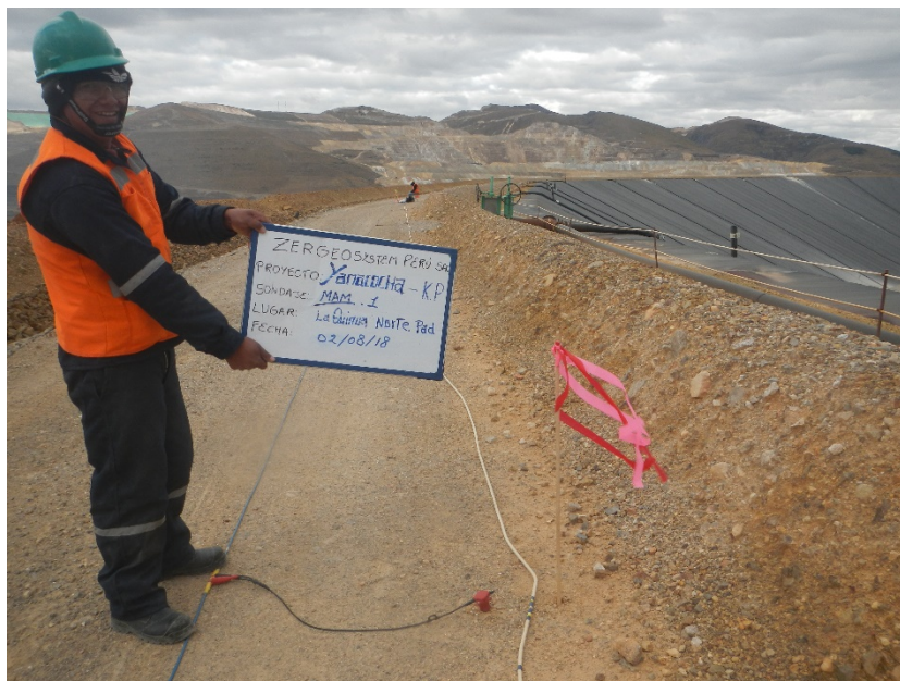
Fotografía 01: Vista panorámica de la zona de trabajo donde se realizó el ensayo sísmico MAM-01. Se observa el tendido del cable de refracción sísmica, una sogu con medidas de ensayos y los geófonos. Asimismo, se aprecia una estaca con una cinta rosa la cual indica el punto el cual no ha sido replanteado.
