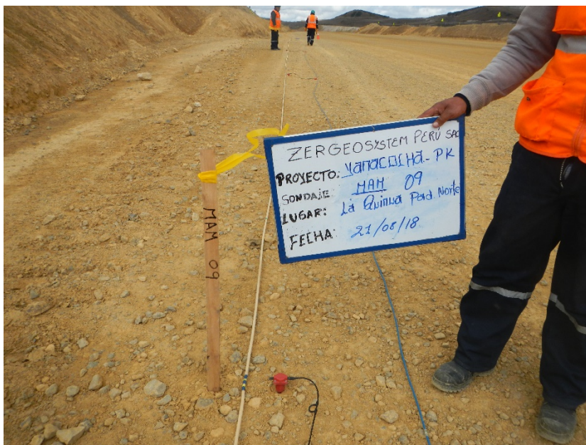
Fotografía 09: Vista panorámica de la zona de trabajo donde se realizó el ensayo sísmico MAM-09. Se observa el tendido del cable de refracción sísmica, una soga con medidas de ensayos y los geófonos. Asimismo, se aprecia una estaca con una cinta amarilla la cual indica el punto el cual ha sido replanteado.
