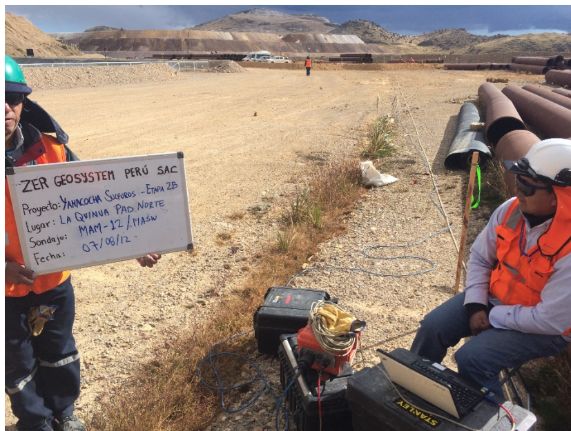
Fotografía 23: Vista panorámica de la zona de trabajo donde se realizó el ensayo sísmico MAM-12. Se observa el tendido del cable de refracción sísmica, una soga con medidas de ensayos y los geófonos. Asimismo, se aprecia una estaca con una cinta verde la cual indica el punto el cual ha sido replanteado.
