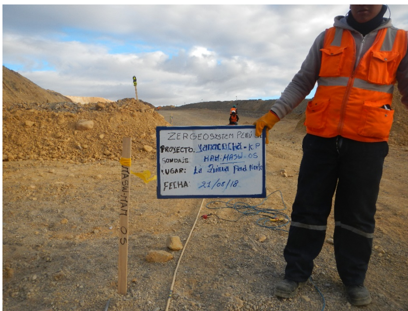
Fotografía 10: Vista panorámica de la zona de trabajo donde se realizó el ensayo sísmico MASW-05. Se observa el tendido del cable trigger, geófonos y el accionar de la comba propia del ensayo.
