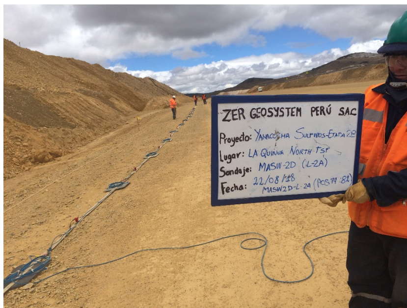
Fotografía 40: Vista panorámica de la zona de trabajo donde se realizó el ensayo sísmico MASW-2D. Se aprecia una faja unida al cable de refracción sísmica y los geófonos. En la fotografía se muestra las posiciones del 79 - 82 del presente ensayo.
