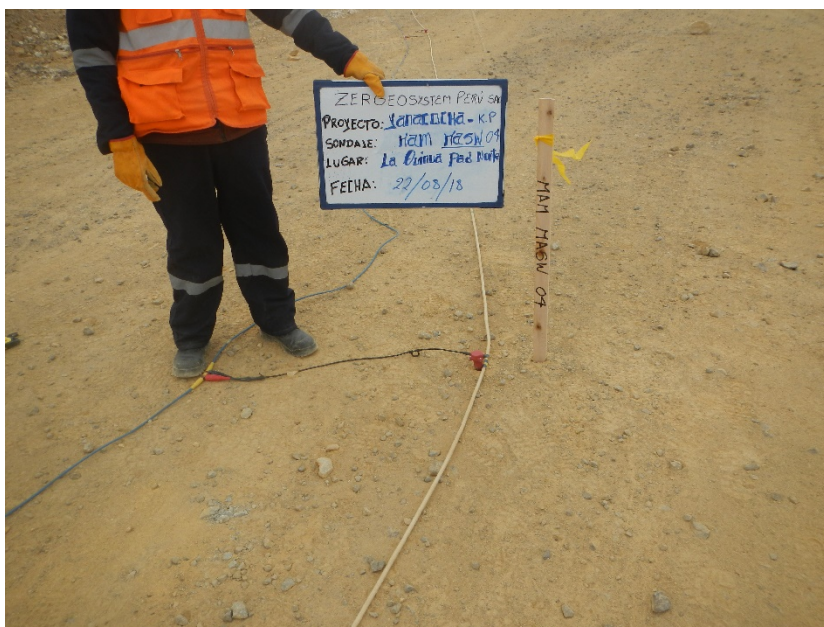
Fotografía 07: Vista panorámica de la zona de trabajo donde se realizó el ensayo sísmico MAM-04. Se observa el tendido del cable de refracción sísmica, una soga con medidas de ensayos y los geófonos. Asimismo, se aprecia una estaca con una cinta amarilla la cual indica el punto el cual ha sido replanteado.
