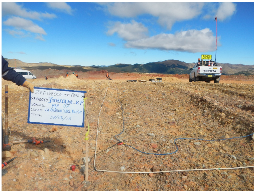
Fotografía 07: Vista panorámica de la zona de trabajo donde se realizó el ensayo sísmico MAM-07. Se observa el tendido del cable de refracción sísmica, una soga con medidas de ensayos y los geófonos. Asimismo, se aprecia una estaca con una cinta amarilla la cual indica el punto el cual ha sido replanteado.
