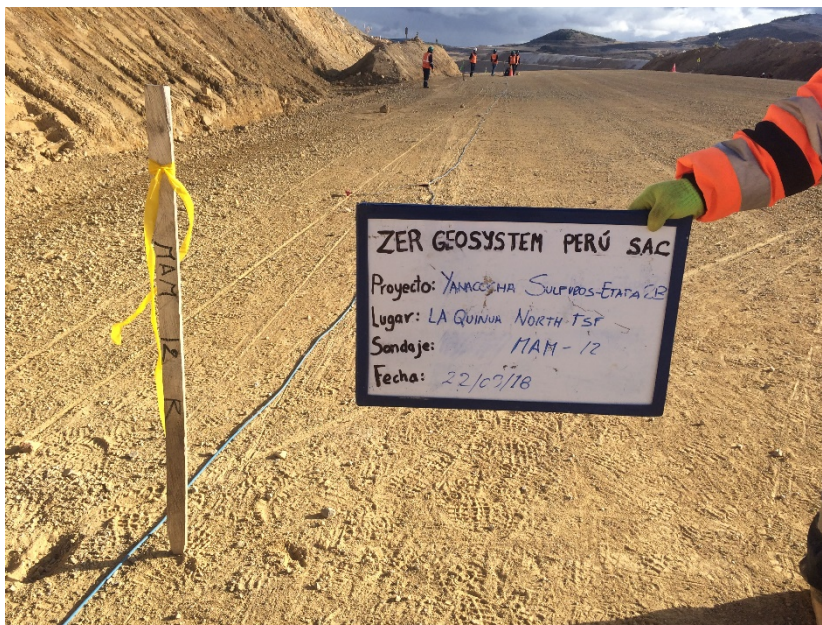
Fotografía 12: Vista panorámica de la zona de trabajo donde se realizó el ensayo sísmico MAM-12. Se observa el tendido del cable de refracción sísmica, una soga con medidas de ensayos y los geófonos. Asimismo, se aprecia una estaca con una cinta amarilla la cual indica el punto el cual ha sido replanteado.
