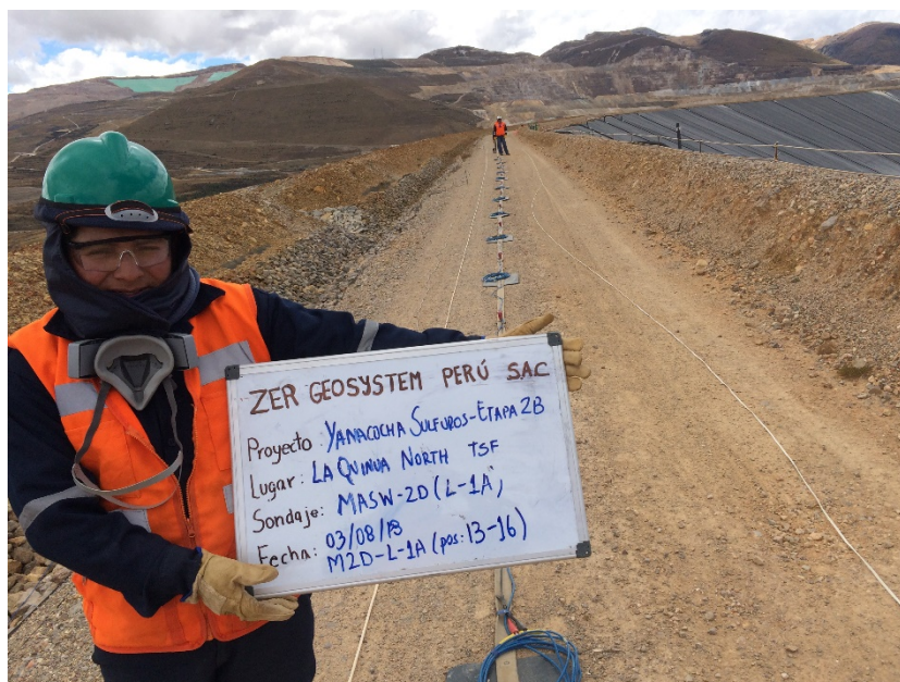
Fotografía 04: Vista panorámica de la zona de trabajo donde se realizó el ensayo sísmico MASW-2D. Se aprecia una faja unida al cable de refracción sísmica y los geófonos. En la fotografía se muestra las posiciones del 13 - 16 del presente ensayo.
