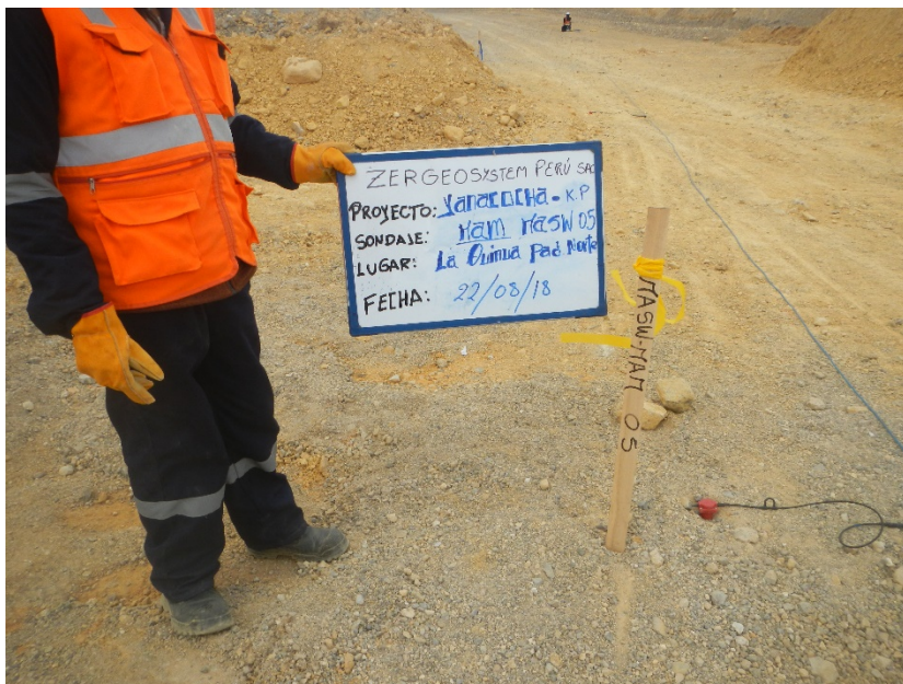
Fotografía 09: Vista panorámica de la zona de trabajo donde se realizó el ensayo sísmico MAM-05. Se observa el tendido del cable de refracción sísmica, una soga con medidas de ensayos y los geófonos. Asimismo, se aprecia una estaca con una cinta amarilla la cual indica el punto el cual ha sido replanteado.
