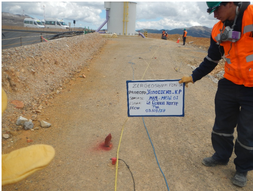
Fotografía 01: Vista panorámica de la zona de trabajo donde se realizó el ensayo sísmico MAM-01. Se observa el tendido del cable de refracción sísmica, una soga con medidas de ensayos y los geófonos.
