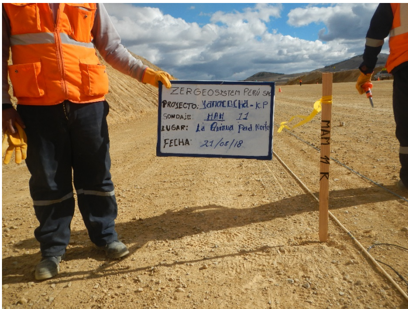
Fotografía 11: Vista panorámica de la zona de trabajo donde se realizó el ensayo sísmico MAM-11. Se observa el tendido del cable de refracción sísmica, una soga con medidas de ensayos y los geófonos. Asimismo, se aprecia una estaca con una cinta amarilla la cual indica el punto el cual ha sido replanteado.
