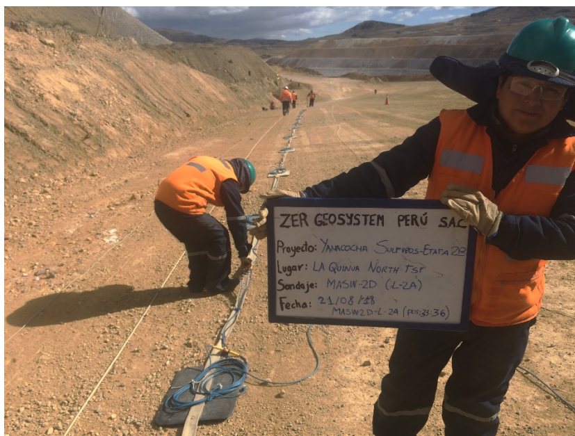
Fotografía 28: Vista panorámica de la zona de trabajo donde se realizó el ensayo sísmico MASW-2D. Se aprecia una faja unida al cable de refracción sísmica y los geófonos. En la fotografía se muestra las posiciones del 33 - 36 del presente ensayo.
