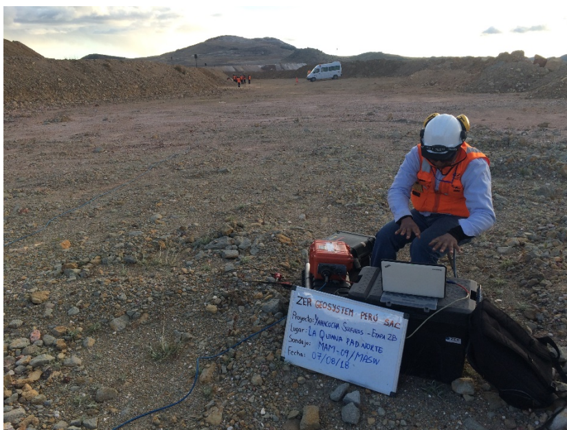
Fotografía 17: Vista panorámica de la zona de trabajo donde se realizó el ensayo sísmico MAM-09. Se observa el tendido del cable de refracción sísmica, una soga con medidas de ensayos y los geófonos. Asimismo, se aprecia una estaca con una cinta amarilla la cual indica el punto el cual ha sido replanteado.
