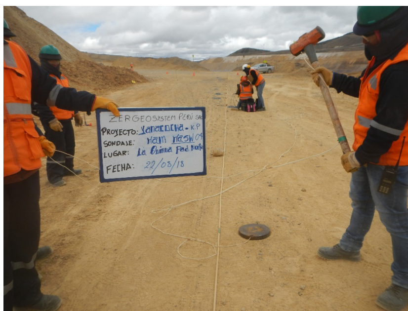
Fotografía 08: Vista panorámica de la zona de trabajo donde se realizó el ensayo sísmico MASW-04. Se observa el tendido del cable trigger, geófonos y el accionar de la comba propia del ensayo.
