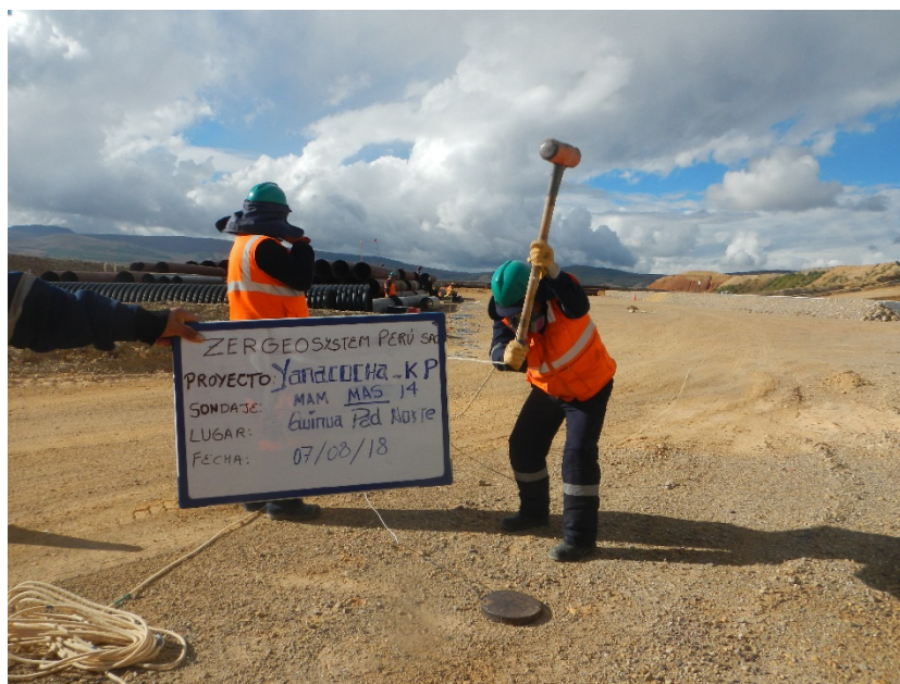
Fotografía 28: Vista panorámica de la zona de trabajo donde se realizó el ensayo sísmico MASW-14. Se observa el tendido del cable trigger, geófonos y el accionar de la comba propia del ensayo.
