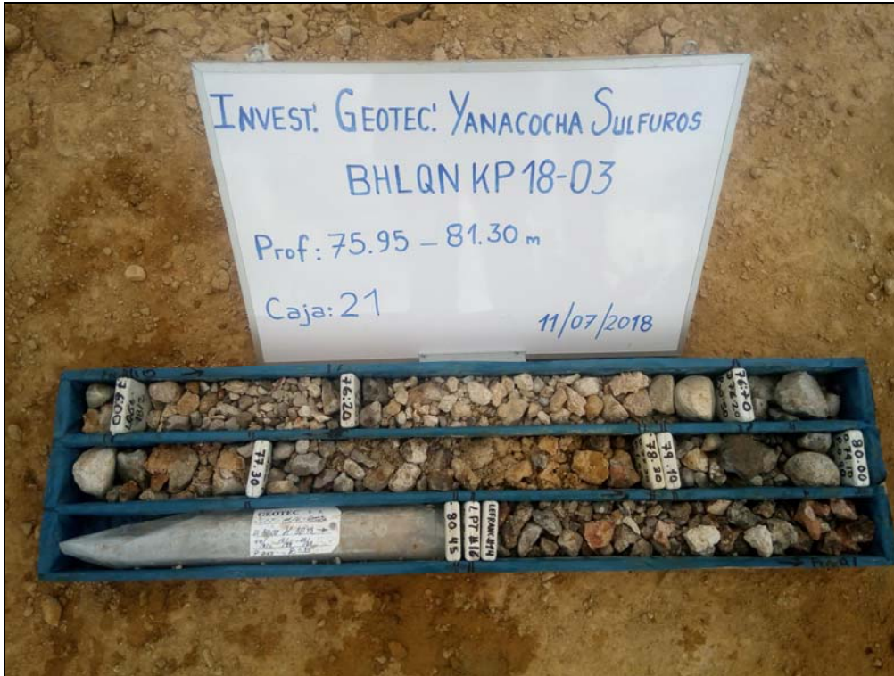
Fotografía 21: Perforación BHLQN KP18-03 De 75,95 m a 81,30 m.
