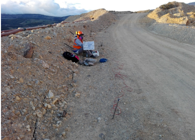
Fotografía 05: Vista panorámica de la zona de trabajo donde se realizó el ensayo sísmico TE-03. Se observa el resistivímetro, la caja multiplexora y los cables eléctricos, los cuales son equipos del presente ensayo. Asimismo, el ingeniero a cargo en la adquisición de data.
