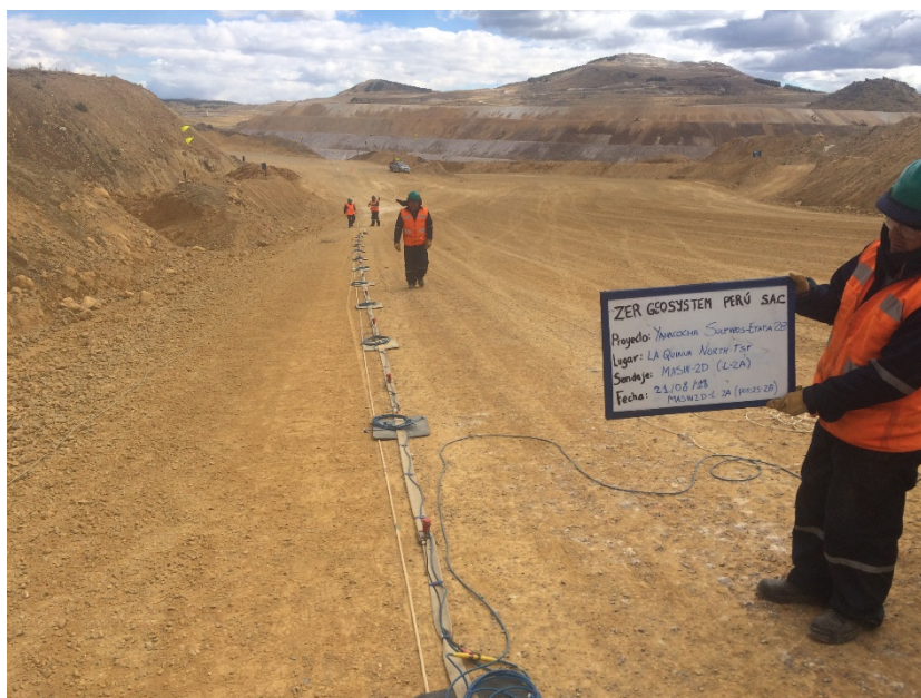
Fotografía 26: Vista panorámica de la zona de trabajo donde se realizó el ensayo sísmico MASW-2D. Se aprecia una faja unida al cable de refracción sísmica y los geófonos. En la fotografía se muestra las posiciones del 25 - 28 del presente ensayo.
