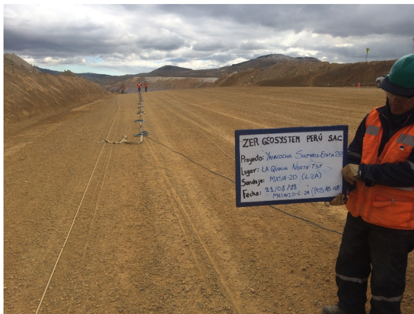
Fotografía 31: Vista panorámica de la zona de trabajo donde se realizó el ensayo sísmico MASW-2D. Se aprecia una faja unida al cable de refracción sísmica y los geófonos. En la fotografía se muestra las posiciones del 45 - 48 del presente ensayo.
