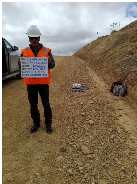
Fotografía 01: Vista panorámica de la zona de trabajo donde se realizó el ensayo sísmico TE-01. Se observa el resistivímetro, la caja multiplexora y los cables eléctricos, los cuales son equipos del presente ensayo.
