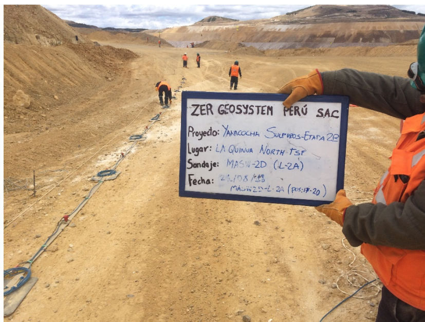
Fotografía 24: Vista panorámica de la zona de trabajo donde se realizó el ensayo sísmico MASW-2D. Se aprecia una faja unida al cable de refracción sísmica y los geófonos. En la fotografía se muestra las posiciones del 17 - 20 del presente ensayo.
