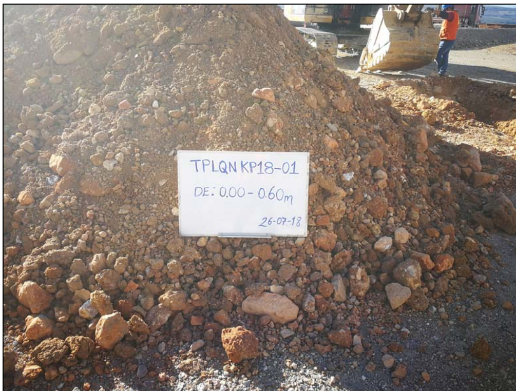
Fotografía 2: Material excavado de la calicata TPLQN KP18-01.
