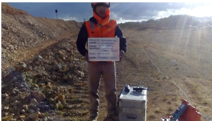
Fotografía 03: Vista panorámica de la zona de trabajo donde se realizó el ensayo sísmico TE-02. Se observa el resistivímetro, la caja multiplexora y los cables eléctricos, los cuales son equipos del presente ensayo. Asimismo, se muestra parte del terreno por donde se traza el ensayo en mención.
