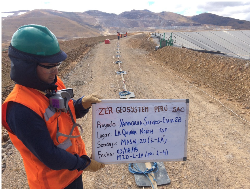
Fotografía 01: Vista panorámica de la zona de trabajo donde se realizó el ensayo sísmico MASW-2D. Se aprecia una faja unida al cable de refracción sísmica y los geófonos. En la fotografía se muestra las posiciones del 01 - 04 del presente ensayo.
