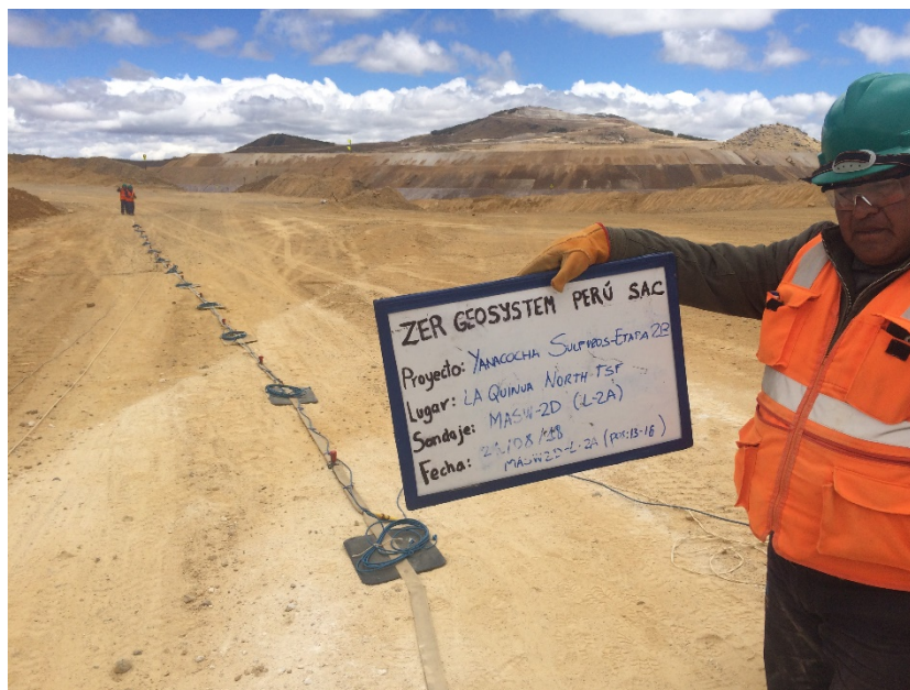
Fotografía 23: Vista panorámica de la zona de trabajo donde se realizó el ensayo sísmico MASW-2D. Se aprecia una faja unida al cable de refracción sísmica y los geófonos. En la fotografía se muestra las posiciones del 13 - 16 del presente ensayo.
