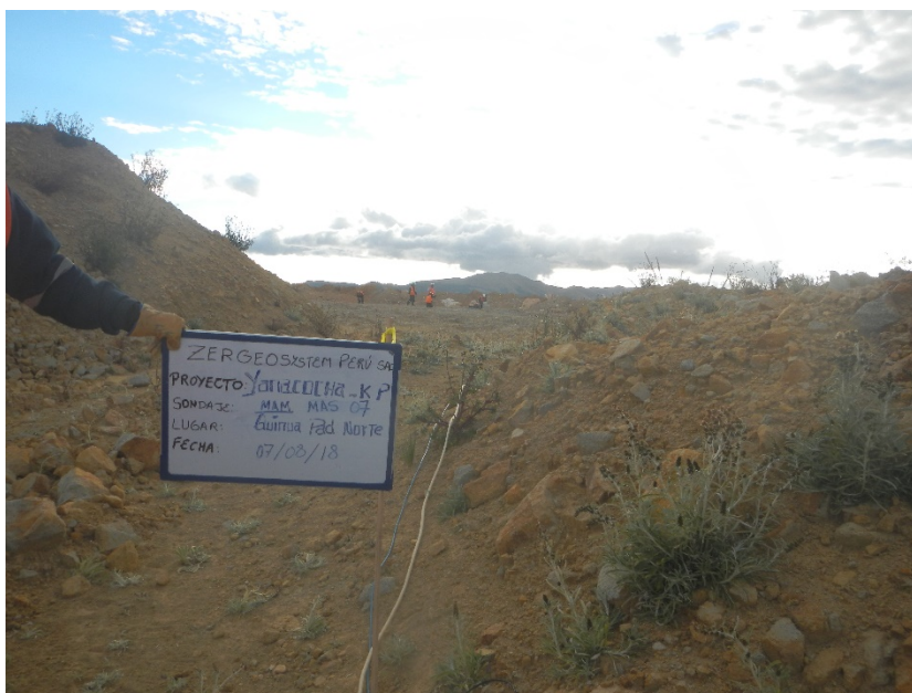
Fotografía 13: Vista panorámica de la zona de trabajo donde se realizó el ensayo sísmico MAM-07. Se observa el tendido del cable de refracción sísmica, una soga con medidas de ensayos y los geófonos. Asimismo, se aprecia una estaca con una cinta amarilla la cual indica el punto el cual ha sido replanteado.
