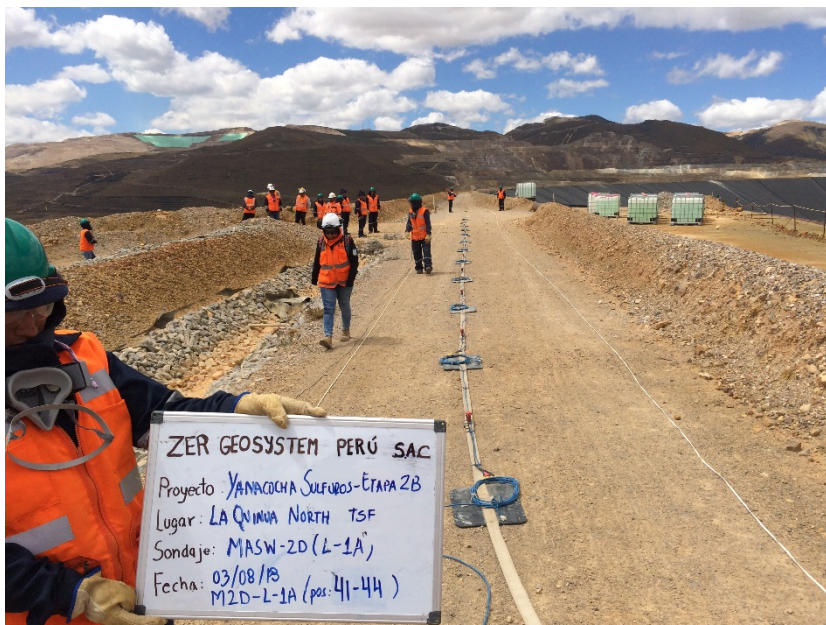
Fotografía 11: Vista panorámica de la zona de trabajo donde se realizó el ensayo sísmico MASW-2D. Se aprecia una faja unida al cable de refracción sísmica y los geófonos. En la fotografía se muestra las posiciones del 41 - 44 del presente ensayo.
