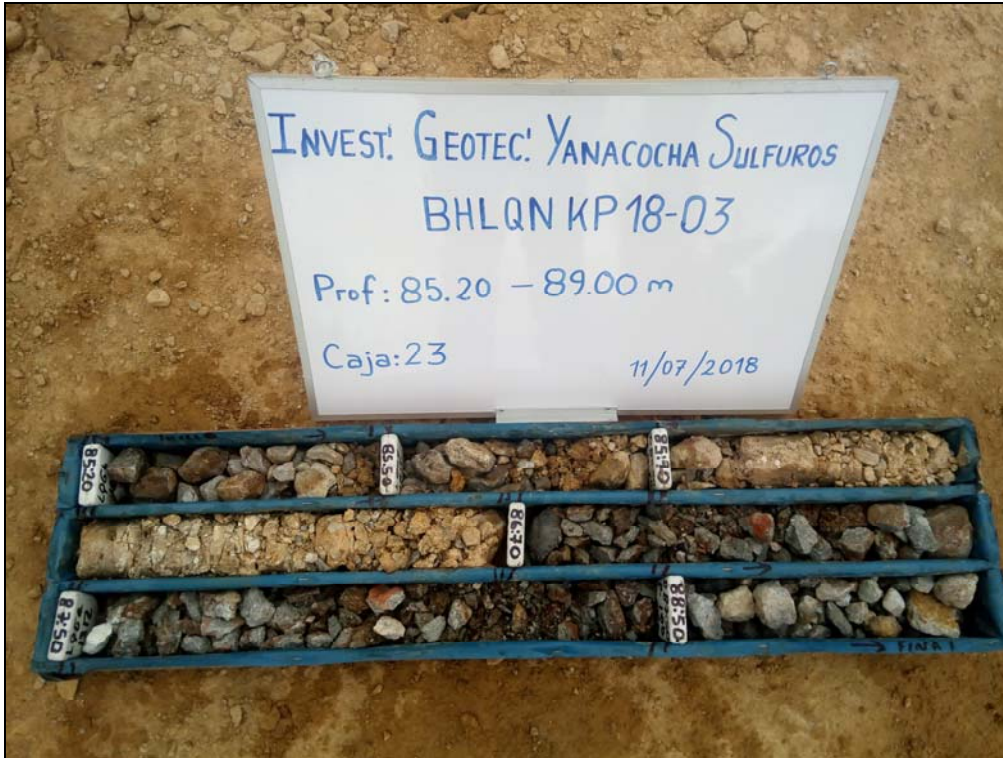
Fotografía 23: Perforación BHLQN KP18-03 De 85,20 m a 89,00 m.
