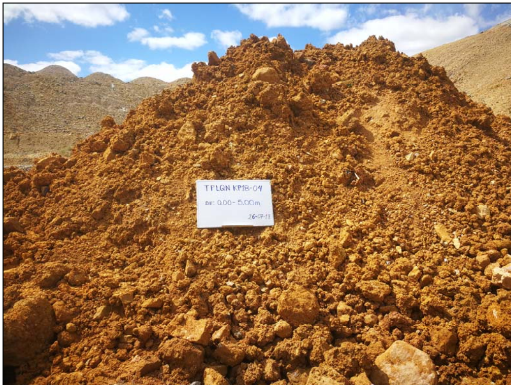
Fotografía 8: Material excavado de la calicata TPLQN KP18-04.
