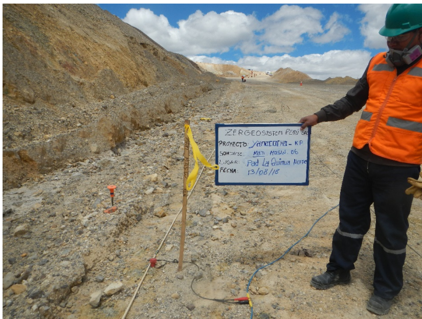
Fotografía 11: Vista panorámica de la zona de trabajo donde se realizó el ensayo sísmico MAM-06. Se observa el tendido del cable de refracción sísmica, una soga con medidas de ensayos y los geófonos. Asimismo, se aprecia una estaca con una cinta amarilla la cual indica el punto el cual ha sido replanteado.
