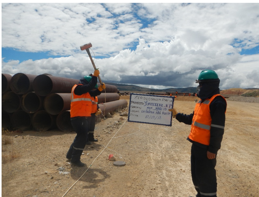
Fotografía 26: Vista panorámica de la zona de trabajo donde se realizó el ensayo sísmico MASW-13. Se observa el tendido del cable trigger, geófonos y el accionar de la comba propia del ensayo.
