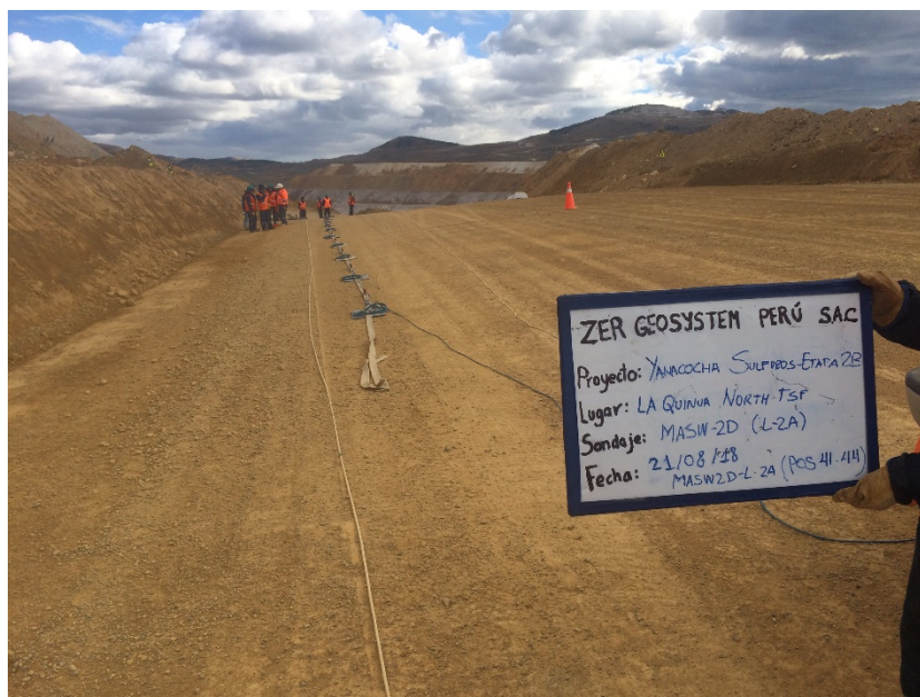
Fotografía 30: Vista panorámica de la zona de trabajo donde se realizó el ensayo sísmico MASW-2D. Se aprecia una faja unida al cable de refracción sísmica y los geófonos. En la fotografía se muestra las posiciones del 41 - 44 del presente ensayo.
