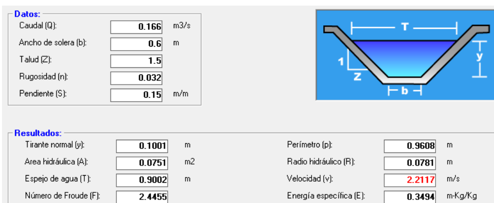
Figura 5: Características Hidráulicas del canal – Pendiente 15%
