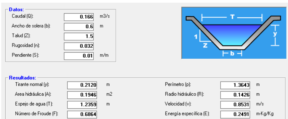
Figura 4: Características Hidráulicas del canal – Pendiente 1%
