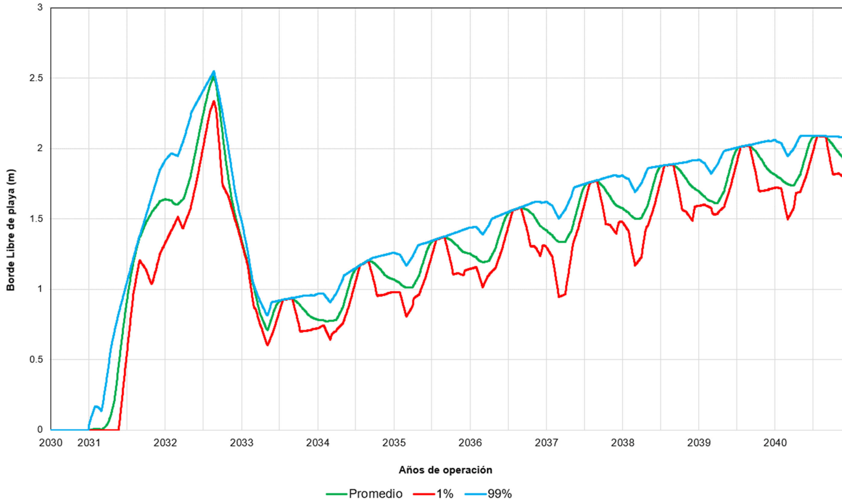
Figura 14: Borde libre de playa para TSF Pampa Larga (distancia entre elevación de relaves en la cara aguas arriba y la elevación de la PMF, 48 horas)
