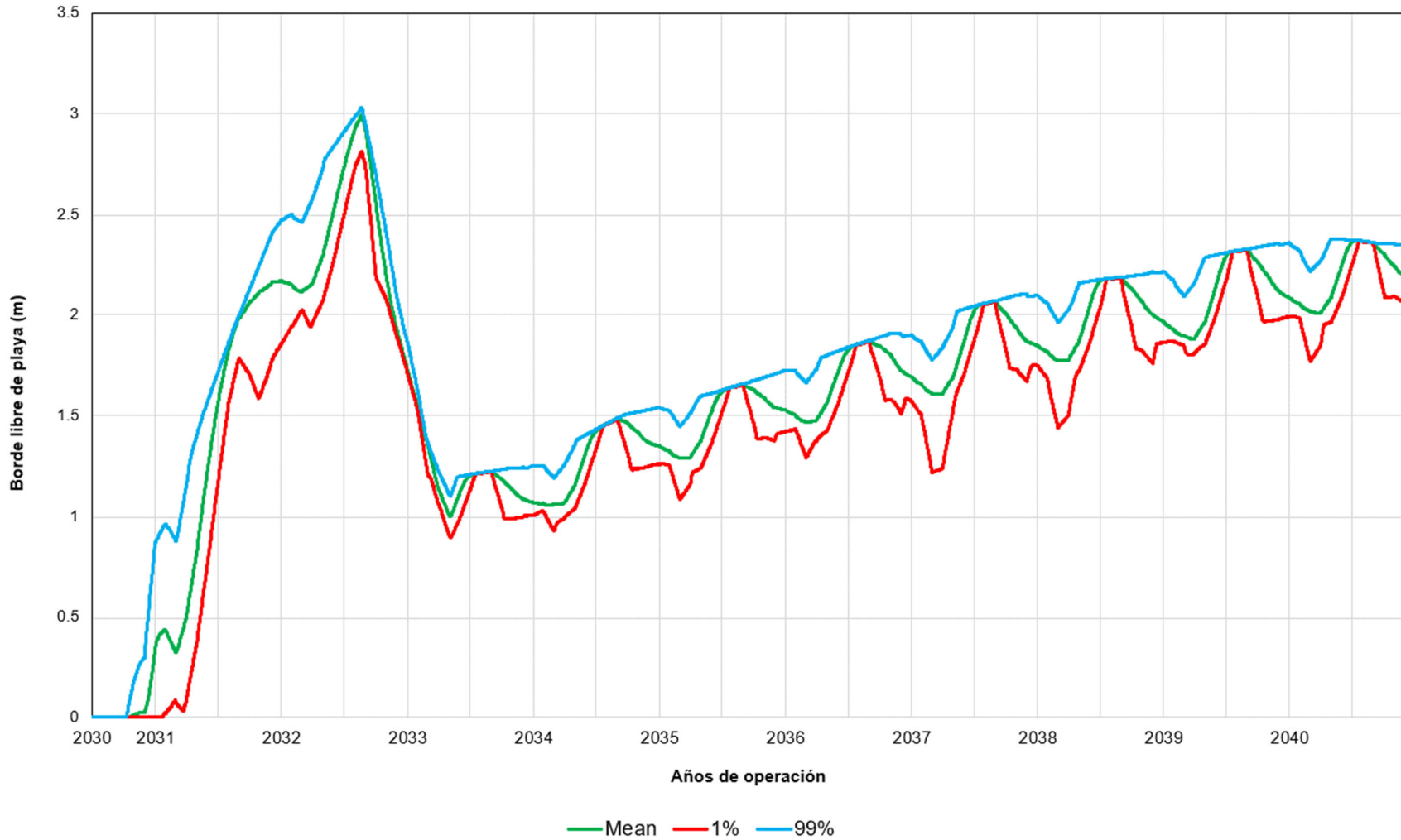
Figura 13: Borde libre de playa para TSF Pampa Larga (distancia entre elevación de relaves en la cara aguas arriba y la elevación de la PMF, 24 horas)
