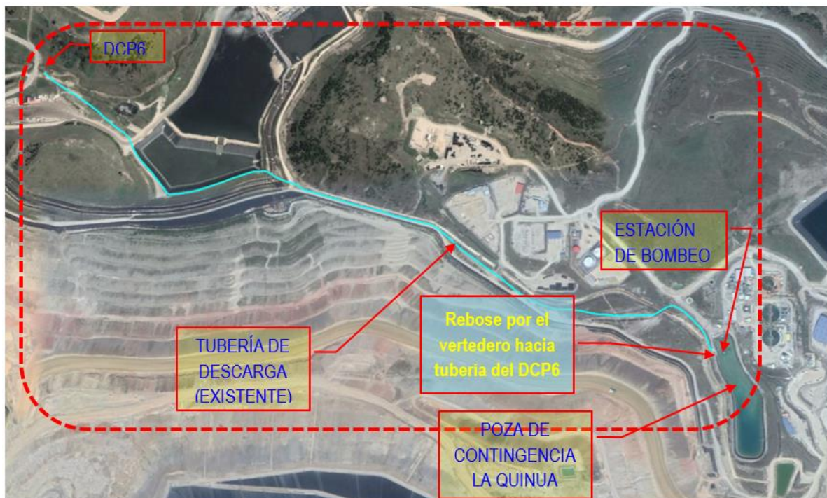
Figura N° 5: Sistema de Bombeo de agua tratada de poza de Contingencia La Quinua
