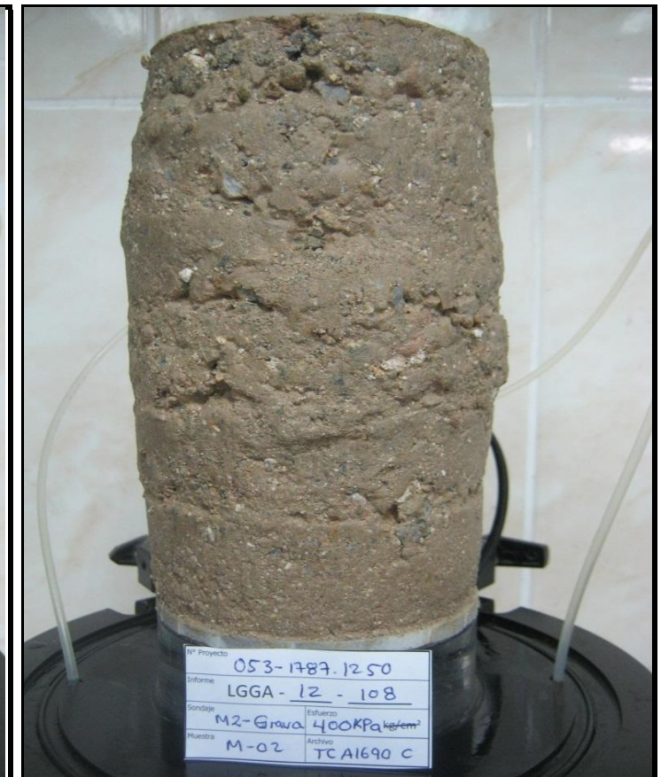
ESPECIMEN 3 Esfuerzo Efectivo Inicial 403 kPa
