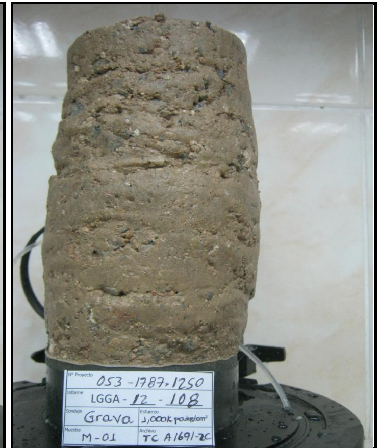
ESPECIMEN 3 Esfuerzo Efectivo Inicial 971 kPa
