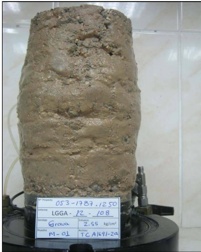
ESPECIMEN 1 Esfuerzo Efectivo Inicial 231 kPa
