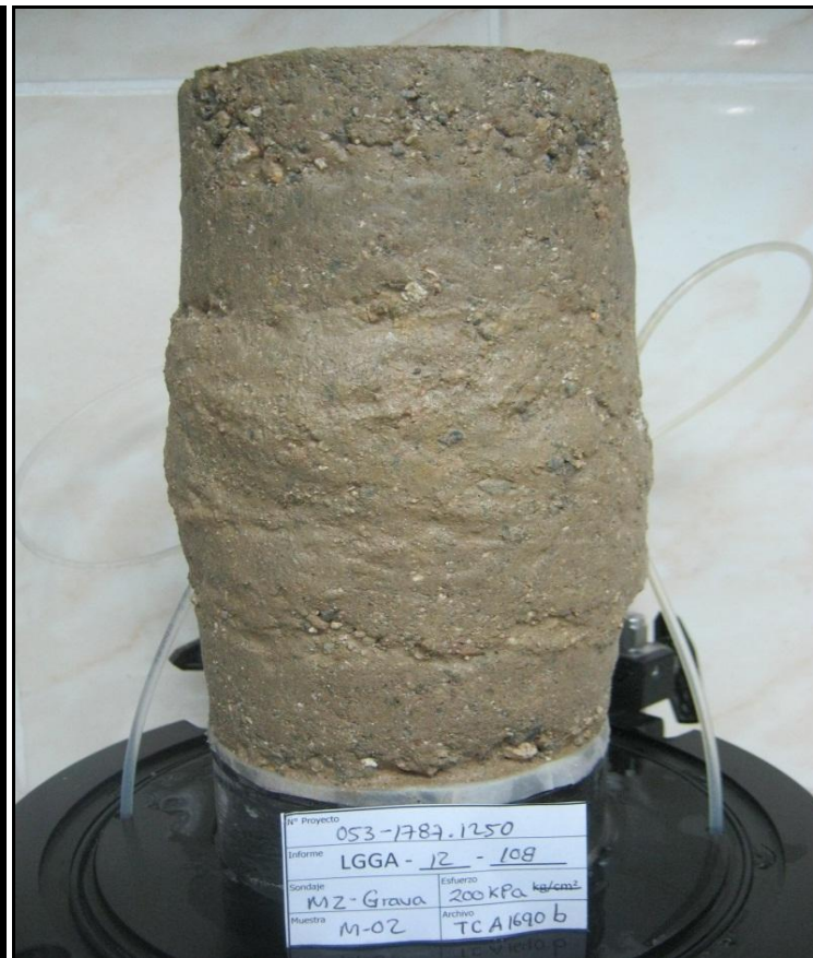
ESPECIMEN 2 Esfuerzo Efectivo Inicial 204 kPa
