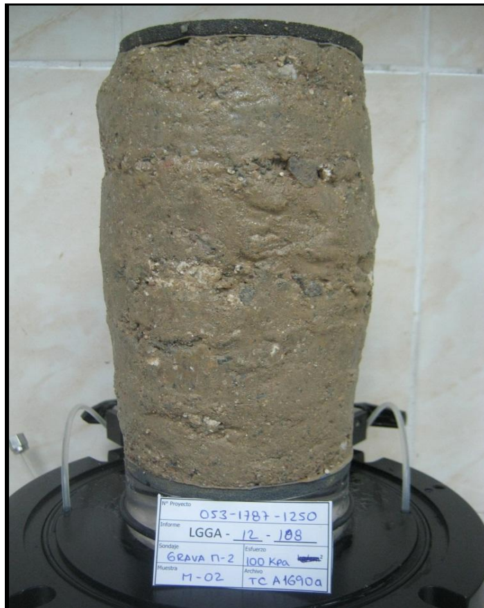
ESPECIMEN 1 Esfuerzo Efectivo Inicial 97 kPa
