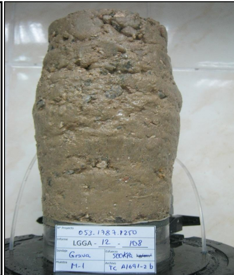
ESPECIMEN 2 Esfuerzo Efectivo Inicial 508 kPa
