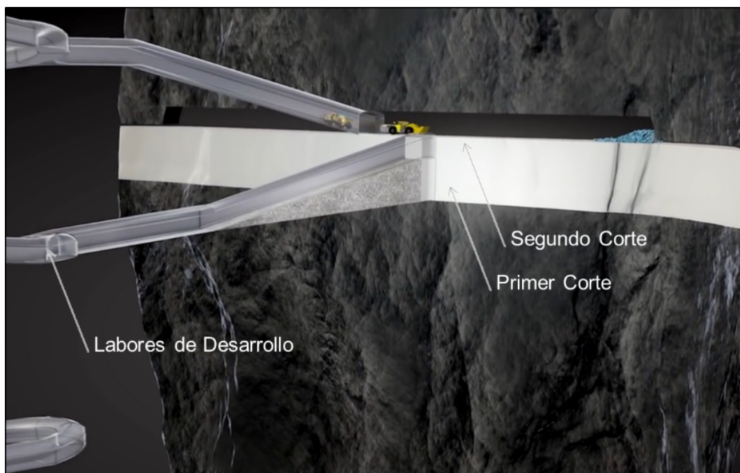
Figura 5-2 Esquema del método de minado corte y relleno con sus variantes ascendente y descendente
