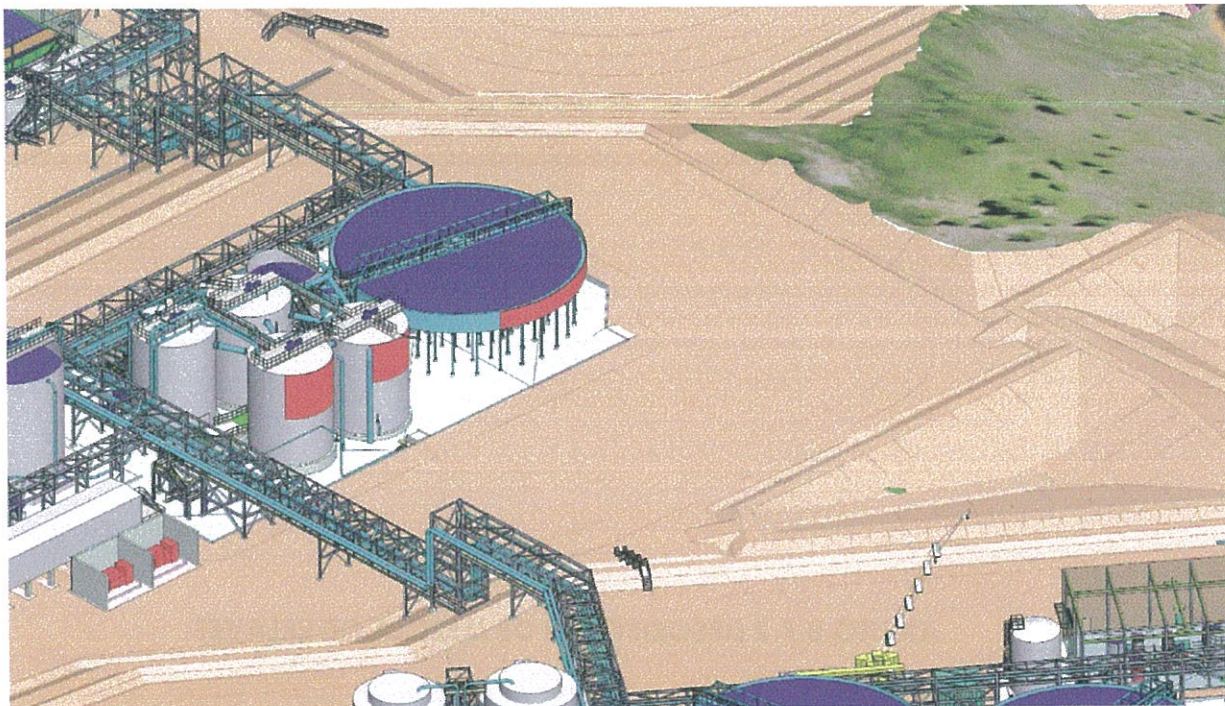
Figura 1-23: La Quinoa Oeste – Tanques de neutralización de solución de refinó y de almacenamiento de roca caliza
