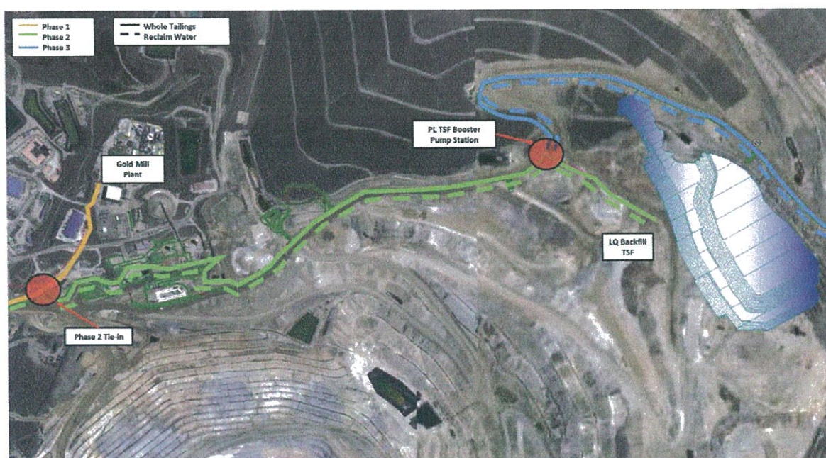
Figura 2-11: Vista en planta del trazo de las tuberías de relaves y agua recuperada (DR La Quinoa)
