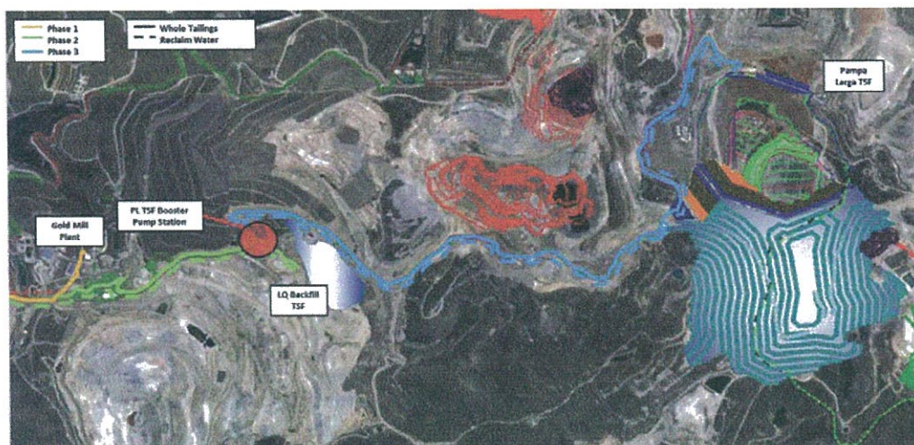
Figura 2-13: Vista en planta del trazo de las tuberías de relaves y agua recuperada (DR Pampa Larga)
