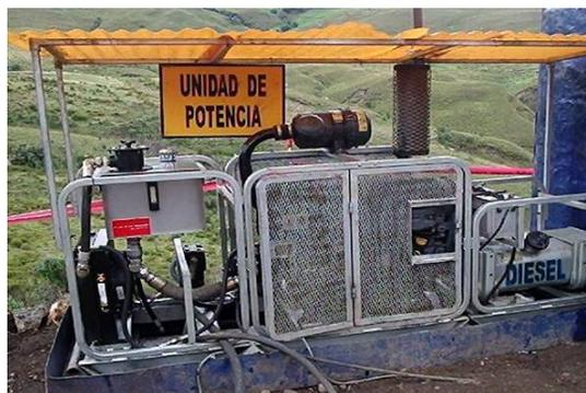
Figura N° 7 Sistema de contención - equipos estacionarios.
