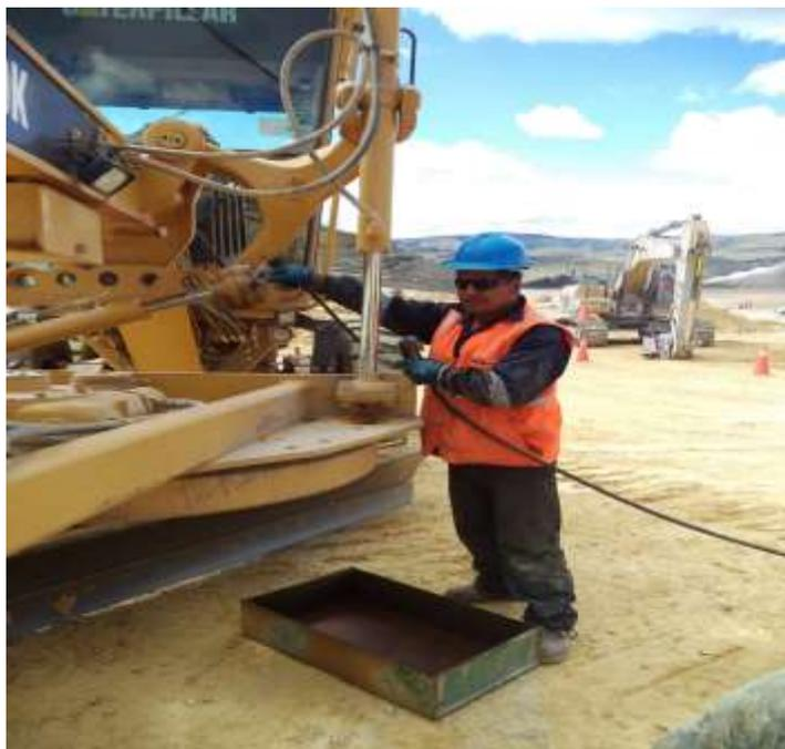
**Figura N° 1** Abastecimiento de lubricantes desde una camioneta. Use una bandeja de contención para contener posibles derrames.
