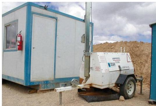
Figura N° 8 Sistema de contención para equipos semi-estacionarios
