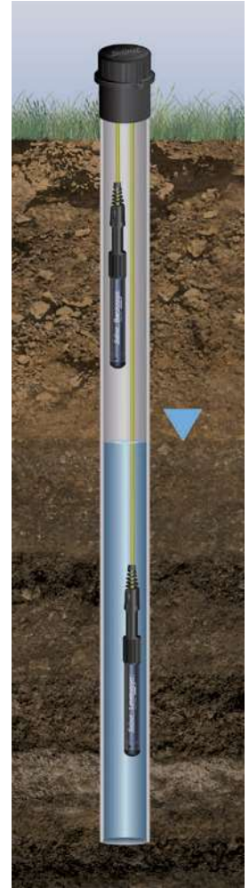
Barologger y Levelogger instalados en un pozo usando Cable de Lectura Directa
