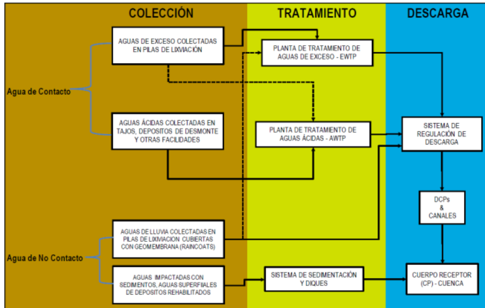
Figura ANA 2-1: Esquema general del Sistema de Manejo de Agua (SIMA) en Yanacocha
