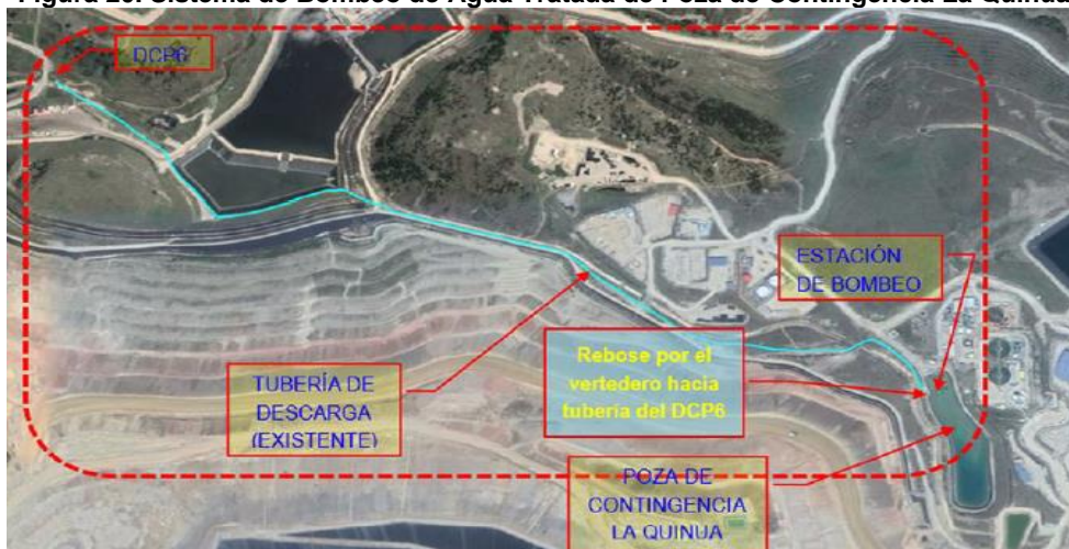
Figura 20. Sistema de Bombeo de Agua Tratada de Poza de Contingencia La Quinua
