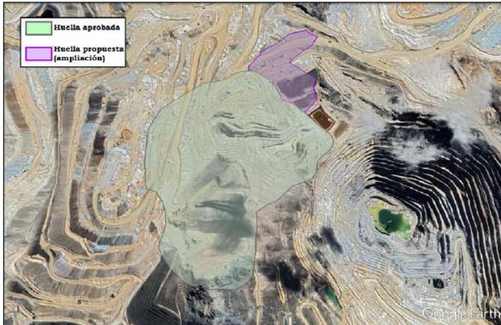
Como parte de las actividades de ampliación del tajo Carachugo Fase III, se han desarrollado actualizaciones a los diseños geotécnico e hidráulico. Por un lado, en el diseño geotécnico se ha evaluado la estabilidad física de secciones críticas de la configuración final del tajo, así como su interacción con componentes adyacentes. Por otro lado, el diseño hidráulico incluye la nueva infraestructura para el manejo de agua de lluvias en las zonas perimetrales de la nueva huella del tajo.
