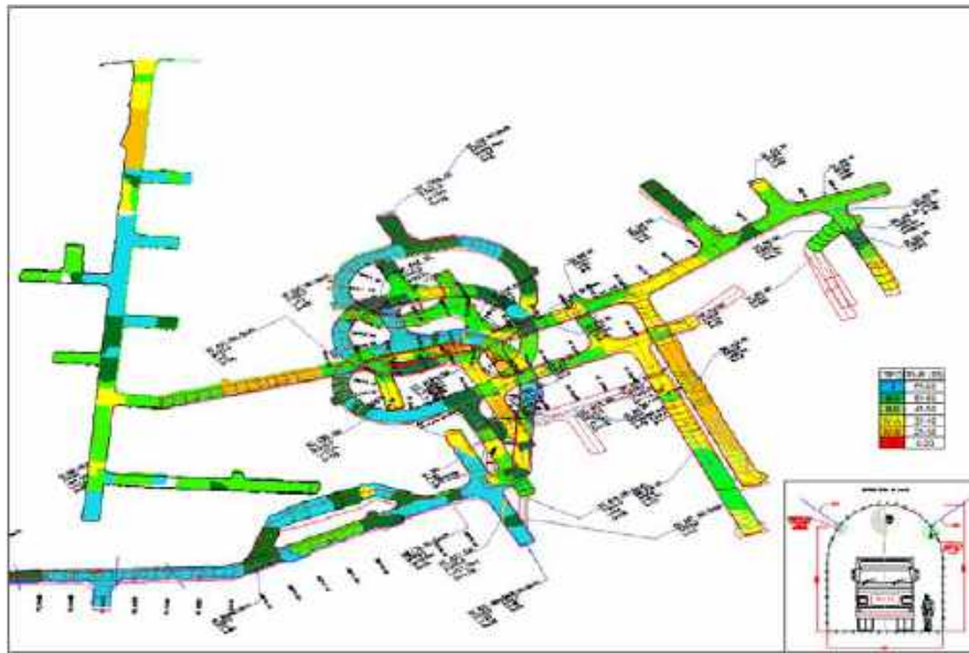
Figura 5-11 Mapeo RMR – Túnel de exploraciones 3800
