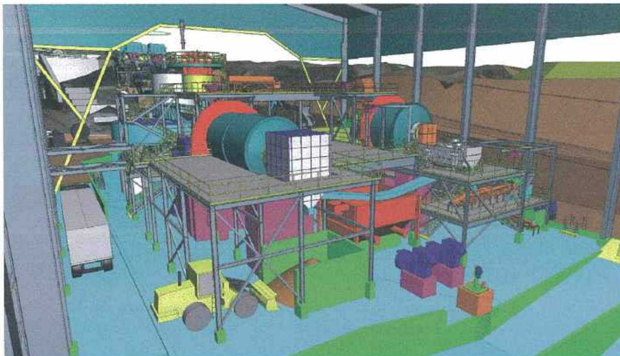
Figura 1-6: La Quinua – molino SAG de mineral bruto y molino de bolas
