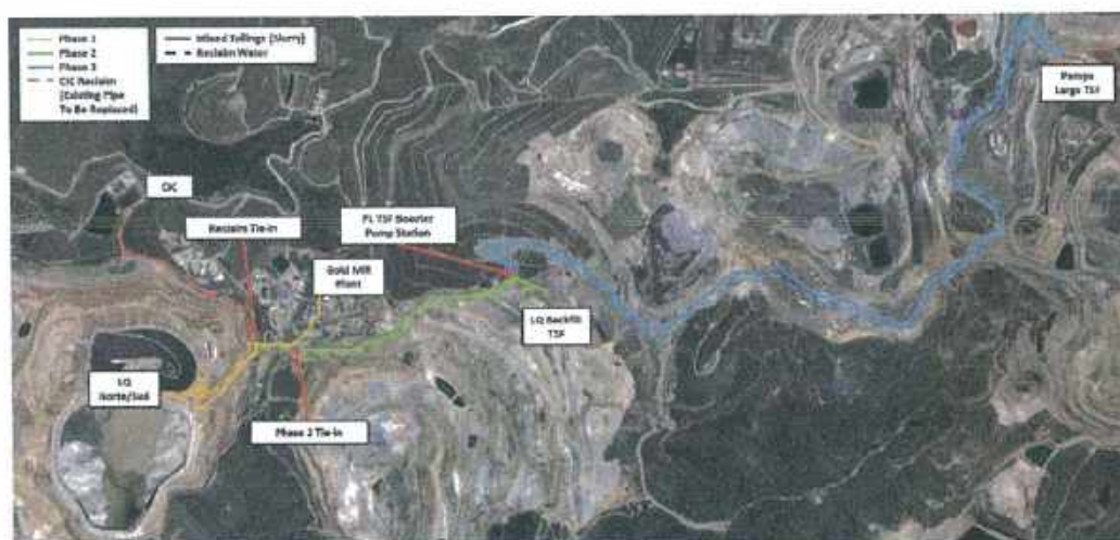
Figura 1-1: Puntos de deposición de relaves mezclados por etapa
