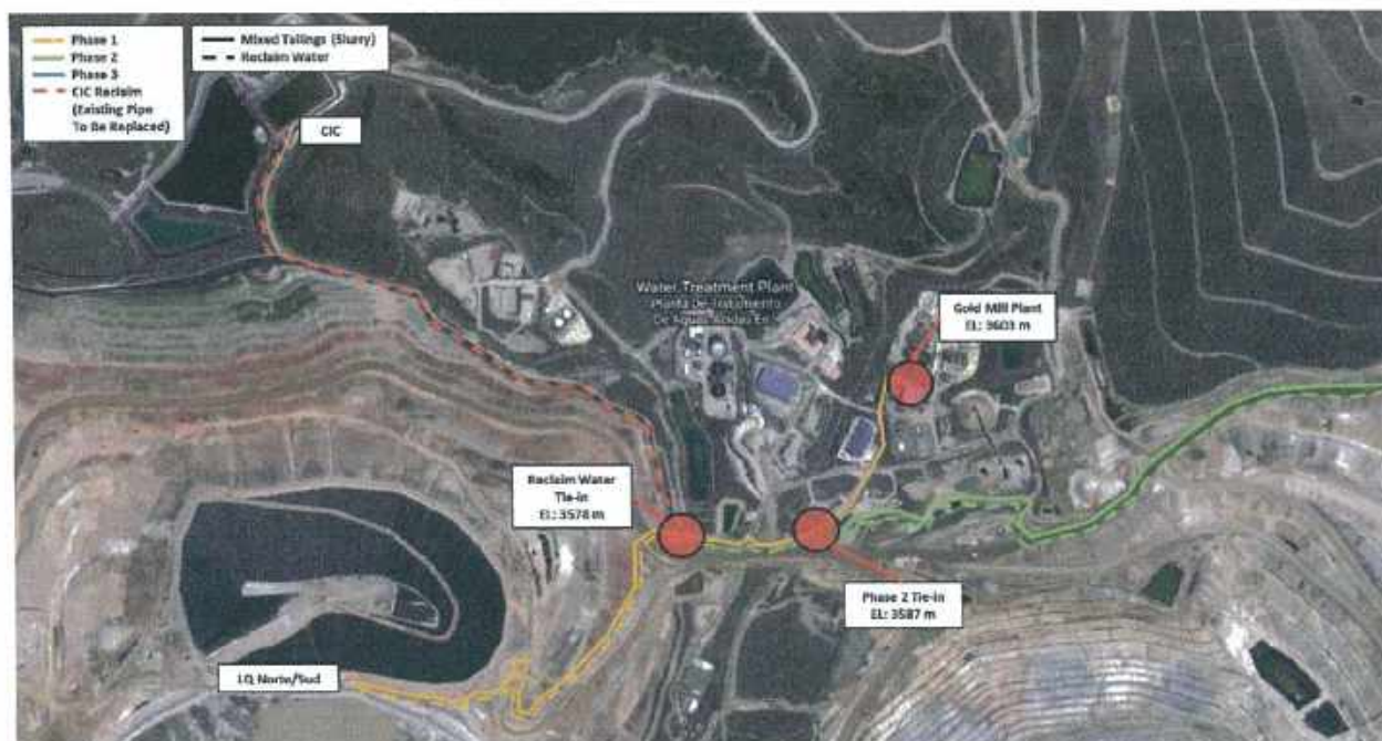
Figura 2-9: Vista en planta del trazado de las tuberías de relaves y agua recuperada
