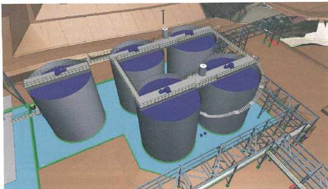
Figura 1-9: La Quinua – Área de tanques de almacenamiento de concentrado/alimentación de oxidación
