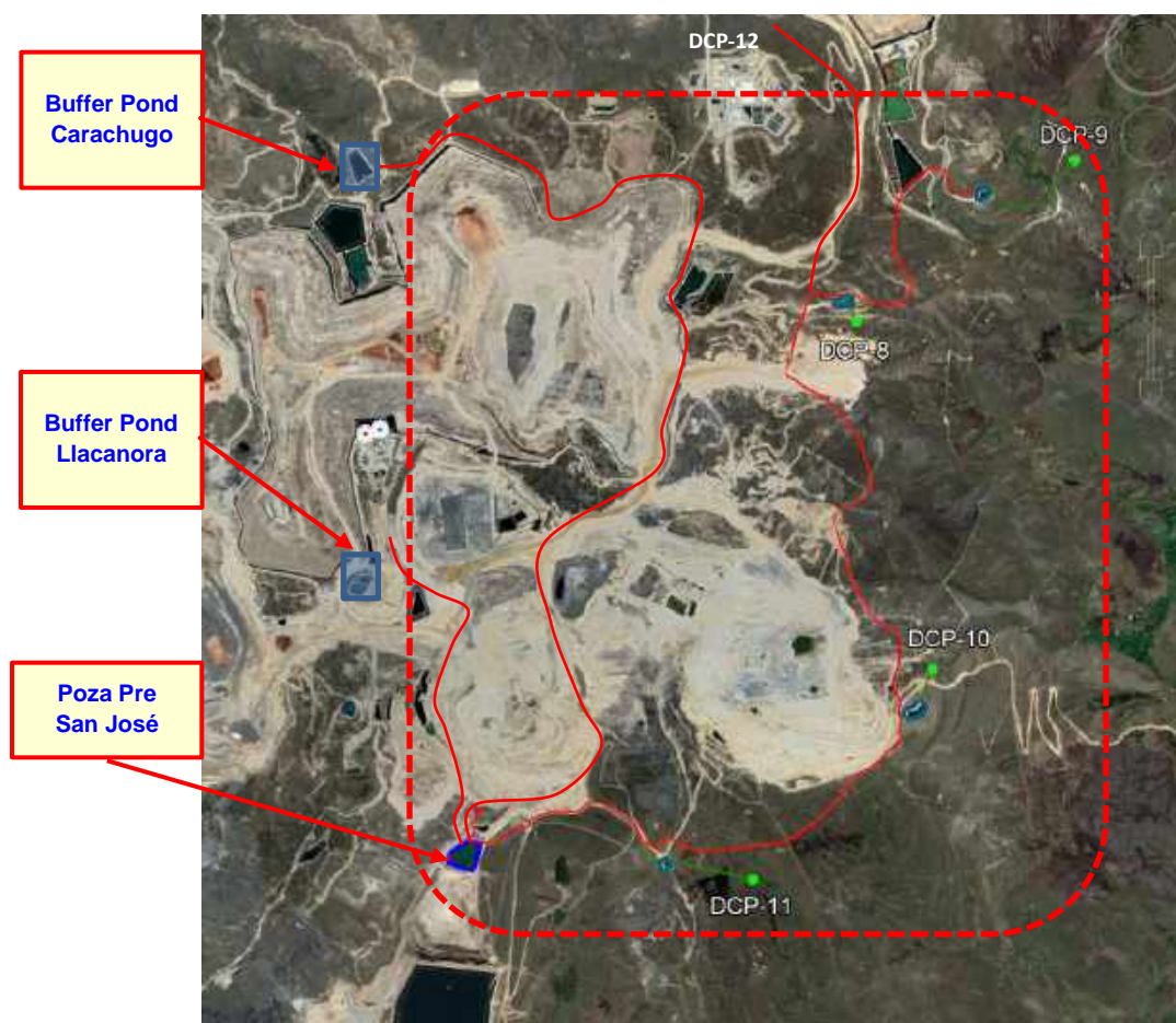
Figura N° 8: Sistema de regulación de descargas propuesto
