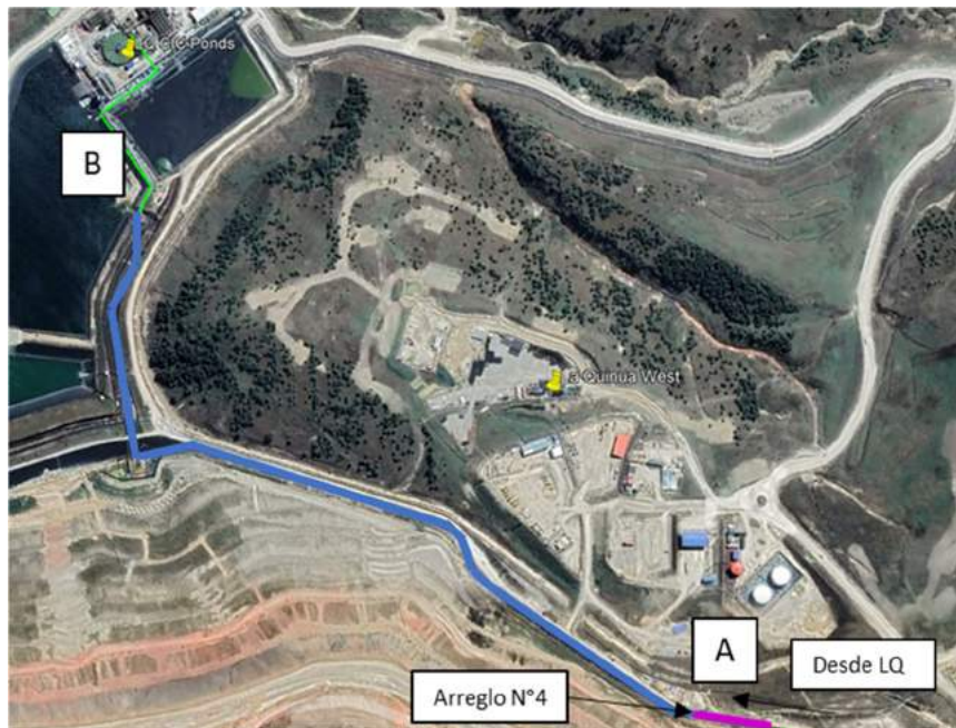
Figura 5-16 Obra general desde el arreglo N°4 de la trinchera (letra A) hasta las piscinas de LQ CIC (letra B). El color azul indica trinchera nueva, mientras que el color rosa indica trinchera extendida (Google Earth, 2022).
