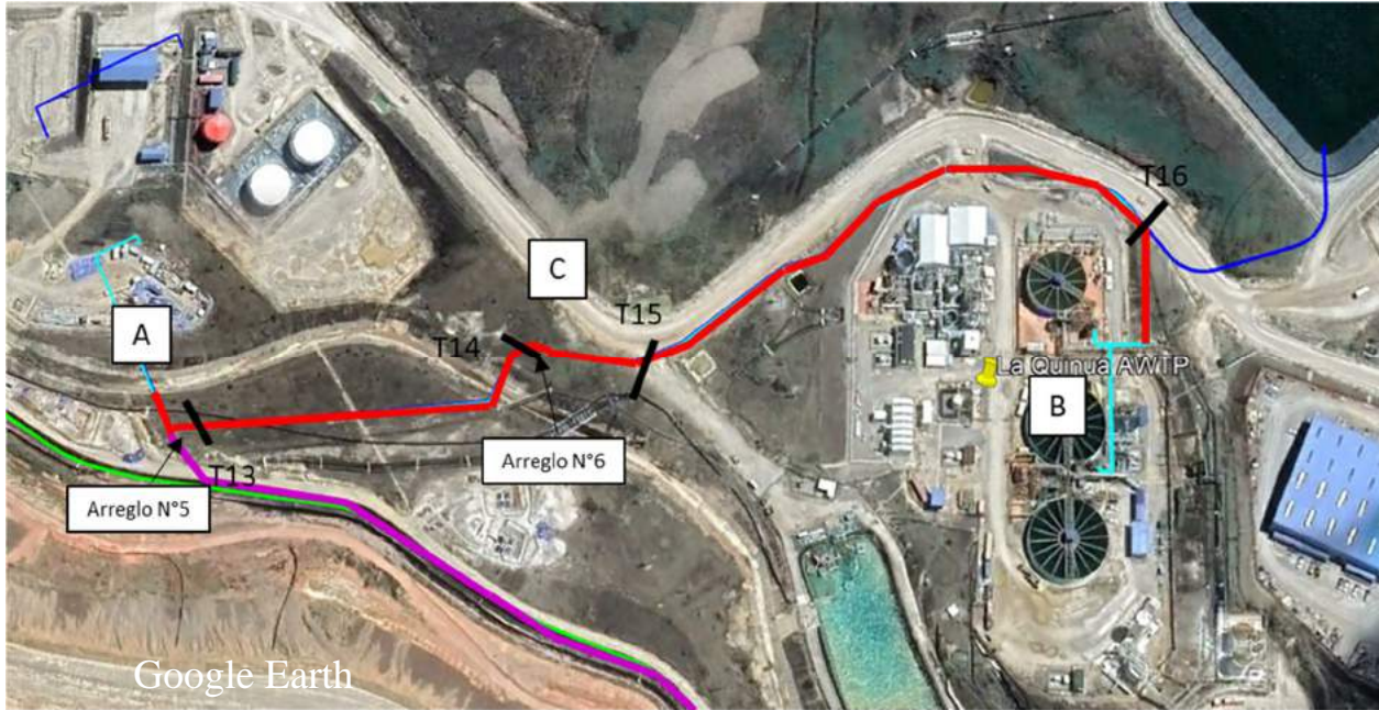
Figura 5-17 Obra general de trinchera desde LQW (letra A) a LQ AWTP (letra B) y la piscina de POX, CCD y PLS (letra C). Color rojo indica tramos de trinchera nueva, color azul indica tramo de trinchera existente y color rosa indica trinchera extendida (Google Earth, 2022).
