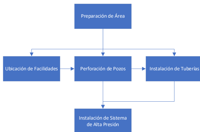
Figura 3. Actividades en la etapa de construcción
