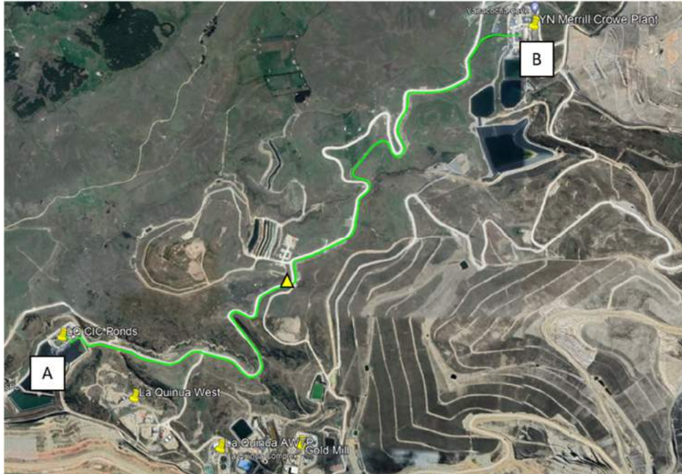
Figura 5-4 Obra general de trinchera desde sitio LQ CIC hasta sitio YN Planta Merrill Crowe. Color verde indica trinchera existente (Google Earth, 2022).
