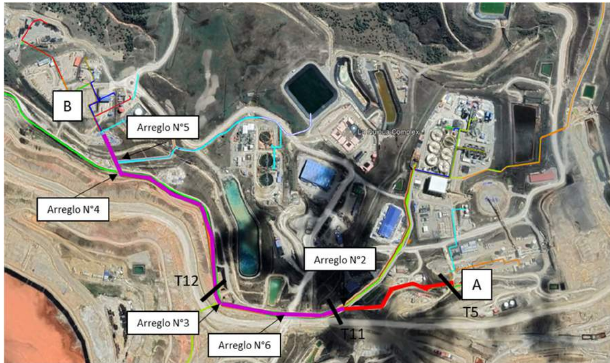
Figura 5-2 Obra general de trinchera desde sitio LQ (letra A) hasta sitio LQW (letra B). El color rojo indica la trinchera nueva y el color rosa indica la trinchera extendida (Google Earth, 2022).
