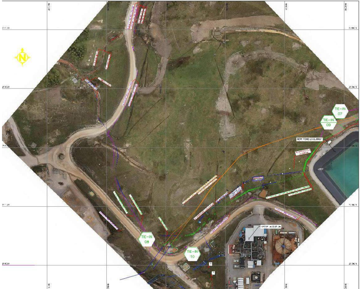
Ilustración 2: Instalación de nuevas tuberías y ubicación de Tie-ins
