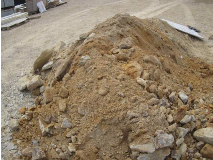
Foto 3: Calicata en el sector Fase III (C-02-13). Se muestra un relleno heterogéneo con tamaño de partícula de hasta 20 cm de diámetro.
