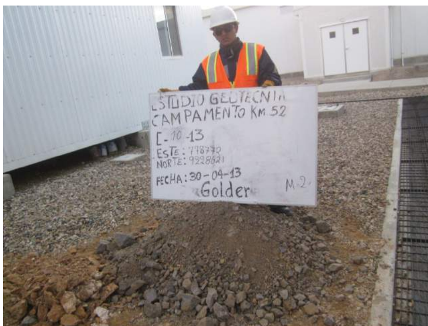
Foto 1: Calicata en el sector Fase I (C-10-13). Se muestra un relleno heterogéneo con tamaño de partícula de hasta 7.5 cm de diámetro.
