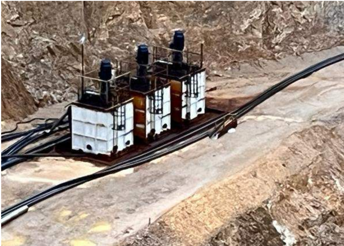
Figura 1: Tanques de rebombeo portátiles modulares, se instalan sobre una superficie plana y se pueden conectar entre ellos para aumentar la capacidad de almacenamiento.
