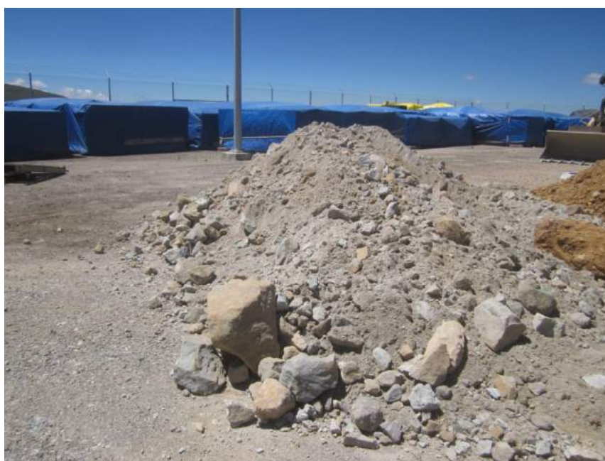
Foto 2: Calicata en el sector Fase II (C-09-13). Se muestra un relleno heterogéneo con tamaño de partícula de hasta 51 cm de diámetro.
