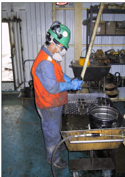
Foto Nº 2: Limpieza de piezas mecánicas. Taller de Componentes Yanacocha Norte.
