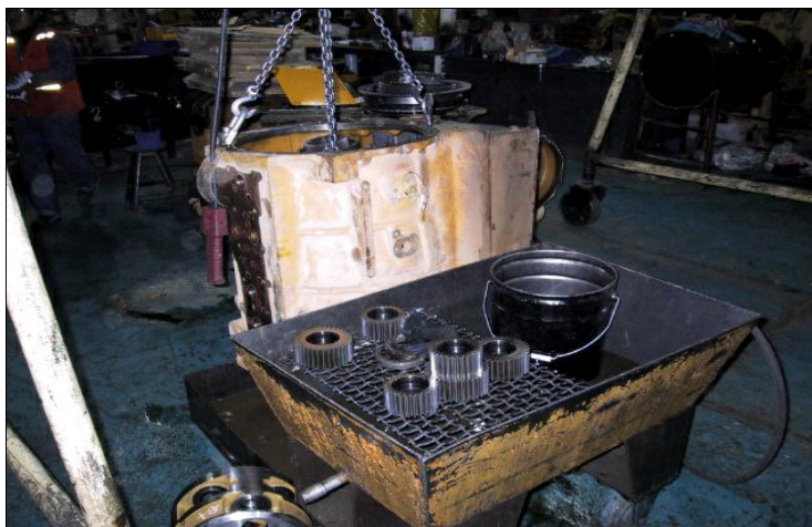
Foto Nº 1: Limpieza de piezas mecánicas. Se recomienda el uso de parrilla y sistema de contención
