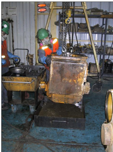
Foto Nº 3: Limpieza de parte mecánica pesada utilizando soporte y dentro del sistema de contención.
