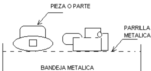
Figura N° 1: Distribución de elementos en la limpieza de partes metálicas
