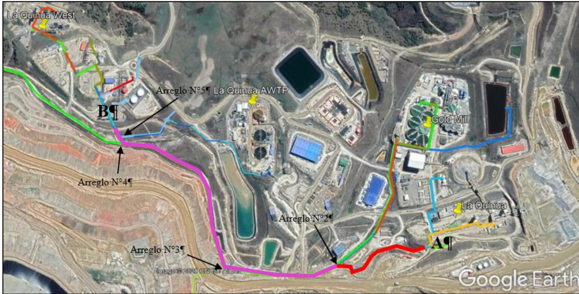
Imagen 9.7.8 Trinchera y tubería de la Planta LQ a LQW
