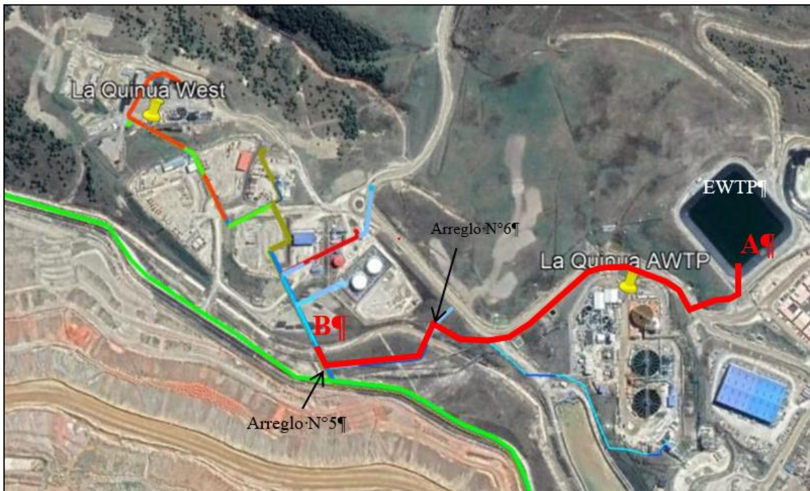
Imagen 9.7.15 Trinchera y tubería de LQW – EWTP
