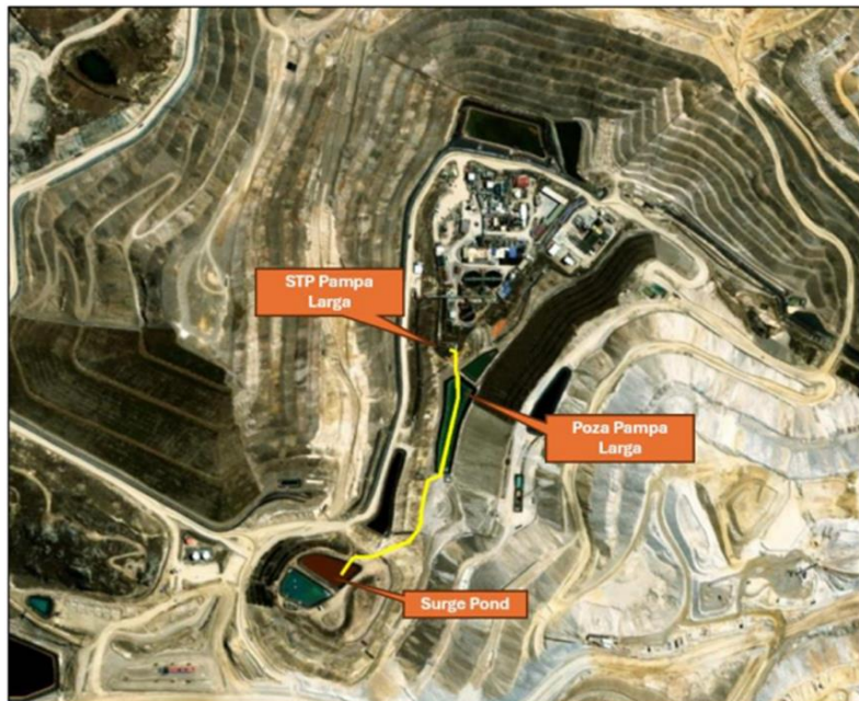
Figura N° 33. Tubería de descarga de la Planta STP en la Poza Pampa Larga
