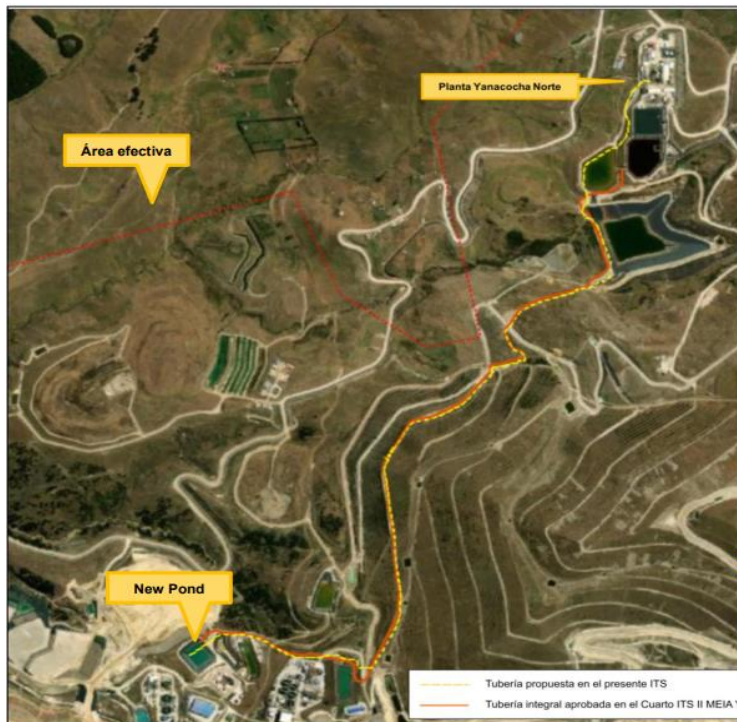
Figura N° 34. Tubería de agua tratada de la planta EWTP (RO) Yanacocha Norte a poza "New Pond"
